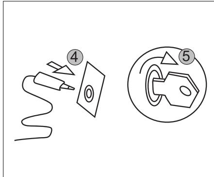
4. Quando o interruptor pneumático estiver na posição “0” (desligado), insira o soquete de energia da bomba de ar no acendedor de cigarros sob o painel de instrumentos;
