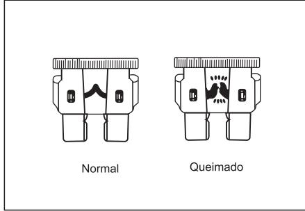
3. Utilize um removedor de fusíveis e remova o fusível queimado. O removedor de fusíveis está localizado na tampa da caixa de fusíveis no compartimento do motor
