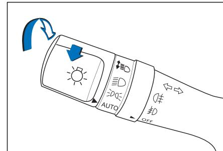
Você pode controlar as luzes girando a extremidade da alavanca. Quando é girado para a posição , a luz de posição, a luz da placa, o painel de instrumento e a luz de fundo dos botões serão acionados.
