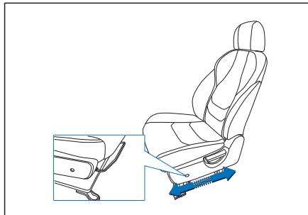
Puxe a alavanca para cima para destravar o banco e permitir seu ajuste para frente e para trás. Após ajustar, certifique-se que o banco está travado adequadamente.
