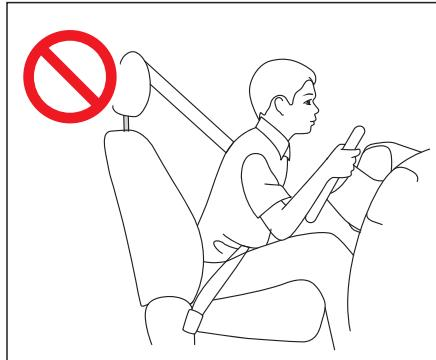
Para reduzir a chance de ferimentos em um acidente e maximizar a proteção do sistema de proteção, todos os ocupantes do veículo devem permanecer sentados enquanto o banco da frente deve estar na posição vertical.
