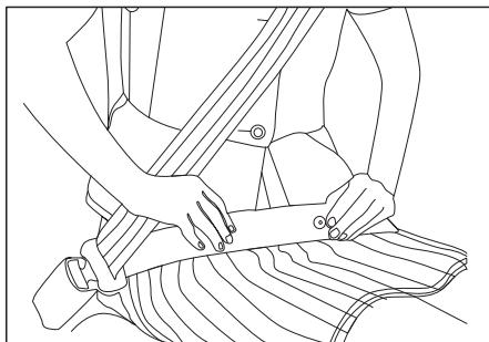
Depois de ajustar o cinto, ele irá expandir automaticamente e contrair para encaixar no seu quadril. Se o cinto de segurança for colocado muito alto e ocorrer um acidente ou frenagem de emergência, o corpo poderá escorregar para fora da parte inferior e causar ferimentos graves.
