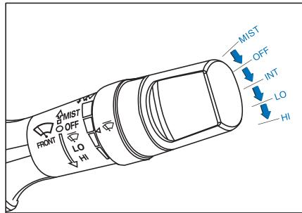
A chave de partida do veículo é colocada na posição ON, a alavanca é levantada, o limpador do para-brisa dianteiro pulveriza a água de limpeza no para-brisa e o limpador funcionará ao mesmo tempo, a alavanca é liberada e o lavador para de funcionar. A alavanca possui cinco velocidades:
