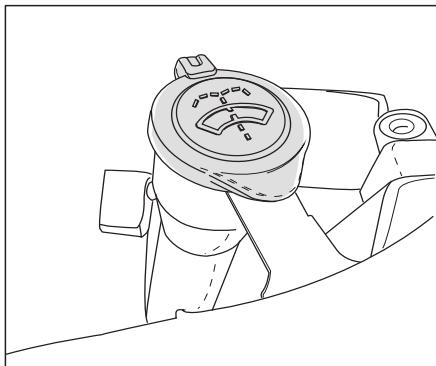
Regularmente, verifique o nível do líquido do limpador de para-brisa dos vidros e adicione-o quando necessário. Recomenda-se que o nível do líquido do limpador de para-brisa seja superior à metade após o enchimento. Em condições frias, o líquido pode congelar e se expandir, danificando o reservatório do líquido do limpador de para-brisa. Nunca adicione líquido excessivamente ao reservatório do líquido do limpador de para-brisa.
