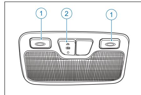
**PORTA:** neste modo, a luz de cortesia frontal acende quando qualquer porta se abre e apaga-se automaticamente quando a porta fica aberta por mais de 30 minutos. Quando a chave de partida estiver na posição LOCK/ACC, feche a porta durante este período e a luz de cortesia frontal apaga após 6 segundos. Quando a chave de partida está na posição ON, a luz de cortesia frontal apaga quando é fechada.
