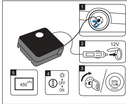
1. Insira o conector/tubo ② na válvula do pneu.
