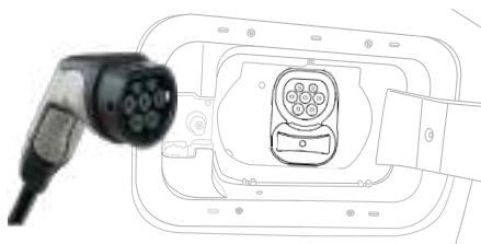
4. Remova o cabo de recarga da estação de carregamento e conecte na interface de carregamento AC (tomada superior) do veículo. Certifique-se de estar bem conectado.
