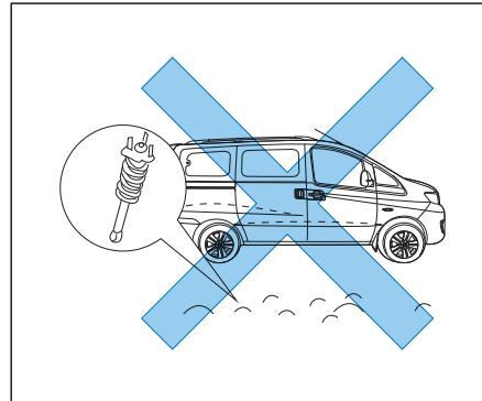
Se a altura do carro alterar, ou a rigidez da suspensão for alterada, o Air-bag pode inflar por engano.
