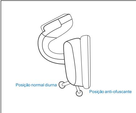
O veículo está equipado com um espelho retrovisor interno. Para ajustá-lo, segure o meio do espelho e ajuste o espelho retrovisor para cima e para baixo ou para a esquerda e direita para ver o veículo atrás. Anti-ofuscamento: o retrovisor conta com uma aba inferior para ajuste anti-ofuscamento. A posição da aba em direção ao painel coloca o retrovisor em modo anti-ofuscamento. Retorne a aba para a direção do para-brisa para o modo normal.
