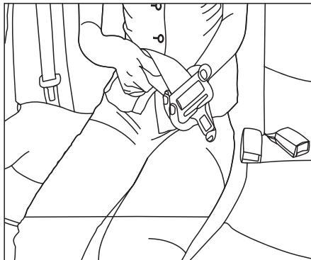
Quando realizar um ajuste no cinto de segurança, mantenha sempre a trava de metal em um ângulo correspondente à fivela e em seguida ajuste o tamanho do cinto. Pressionar a trava de metal facilita o ajuste.
