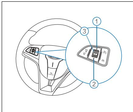
O sistema de controle de cruzeiro permite que o veículo funcione e se mantenha a qualquer velocidade salva sem o uso do acelerador, e a velocidade definida pode mudar em uma subida ou descida.
