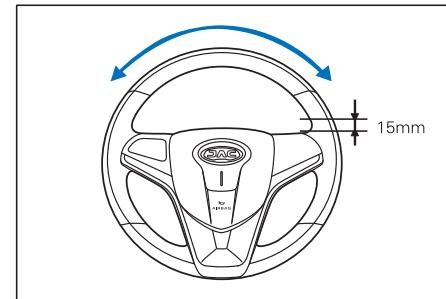
Posicione o volante na posição reta, desligue o motor e então vire levemente o volante para esquerda e direita, verifique a folga quando há resistência.
