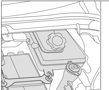
Abra o capô e verifique o fluido de freio no reservatório regularmente. O reservatório está localizado ao lado esquerdo do motor. O nível de líquido deve estar entre as marcas de “MIN” (mínimo) e “MAX” (máximo) na lateral do reservatório.
