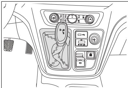
O seletor de marcha é um sistema eletrônico de mudança de marcha com 3 posições: “D” (conduzir), “R” (marcha à ré) e “N” (neutro) e a posição atual do seletor é exibida no painel;
