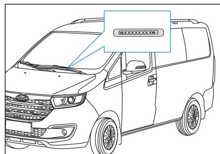
O número de identificação do veículo pode ser localizado na placa no topo do painel do capô ao lado esquerdo do veículo.
