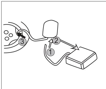
1. Conecte a mangueira pneumática na bomba de ar com a interface do selante de pneus firmemente.
