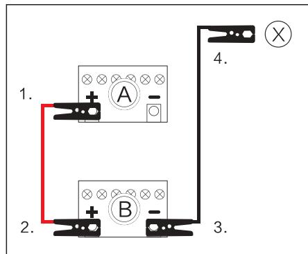
Ao realizar uma partida auxiliar, conecte os cabos na seguinte ordem:
