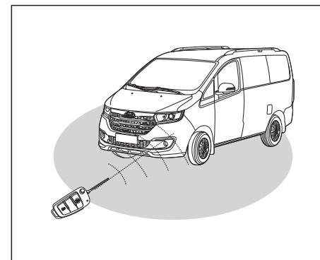
Com o auxílio do controle remoto, a porta pode ser trancada e destrancada sem o uso de uma chave mecânica.
