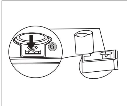
6. Mude o interruptor pneumático para a posição “I” (ligado) para encher;
