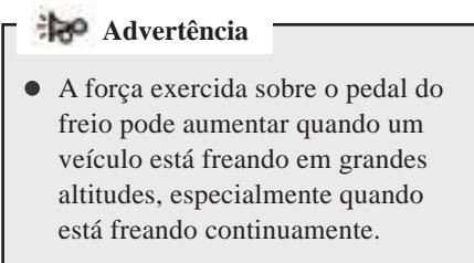
O veículo possui um sistema de freio hidráulico de circuito duplo. Se um circuito de frenagem falhar, o outro circuito ainda pode frear, mas a distância de frenagem aumentará. O sistema de frenagem do veículo também possui uma função de recuperação de energia.
