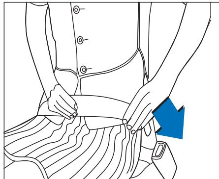
Puxe o cinto de segurança do retrator e insira a lingueta de bloqueio na fivela. Quando você ouvir um “clique”, o cinto de segurança estará travado na fivela. Somente após o travamento do cinto você poderá realizar o ajuste manual para que ele se encaixe adequadamente no seu quadril.
