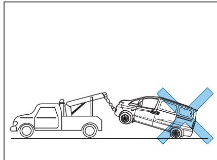
Evite rebocar um veículo elétrico com o eixo de tração tocando o solo.
