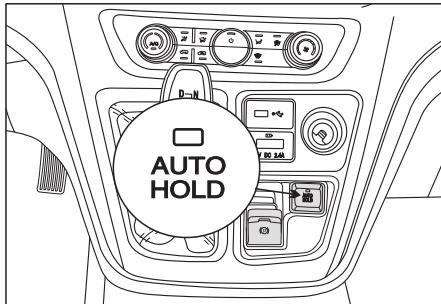
O AUTO HOLD aciona automaticamente o freio de estacionamento ao parar, sem que o condutor pressione o pedal de freio ou acione manualmente o freio de estacionamento.
