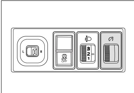
O rolo de ajuste de brilho está localizado ao lado direito do painel de instrumentos. Gire o rolo para ajustar a intensidade do brilho do painel de instrumentos. O botão de ajuste de brilho do instrumentos está localizado no grupo de interruptores no lado inferior esquerdo dos instrumentos.
