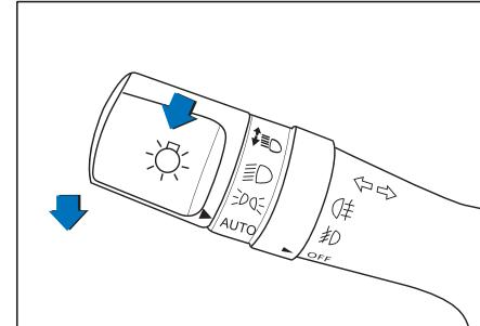
Para lampejar o farol alto, puxe a alavanca levemente para trás e solte-a. Neste momento, a luz do farol alto irá acender e logo apagar. Mesmo se a alavanca estiver na posição “OFF”, o farol irá piscar. Se a alavanca for puxada e não for liberada rapidamente, a luz do farol alto permanecerá acesa enquanto a alavanca permanecer puxada.
