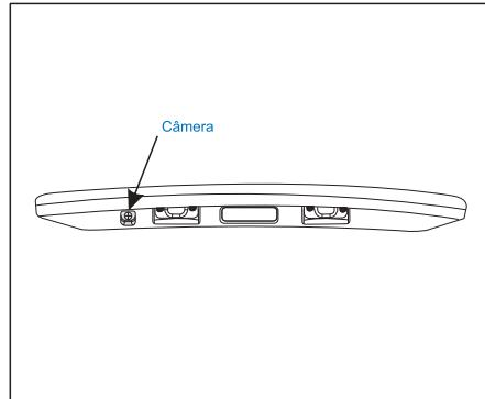
Durante a marcha à ré o sistema da câmera de ré captura a imagem do tráfego atrás do veículo e exibe no multimídia para providenciar assistência e informações das condições da rodovia. Esse é um sistema auxiliar e o motorista precisa prestar atenção as condições na traseira e conduzir com cuidado.
