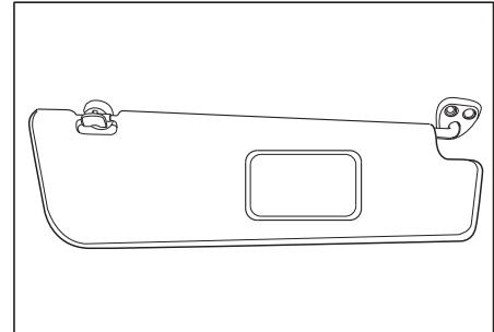
O veículo está equipado com dois para-sóis, que devem ser puxados para baixo para proteger o condutor e o passageiro da luz solar dianteira. Quando houver necessidade de utilizar proteção contra o sol lateral, pode-se desencaixar o para-sol do suporte e girar ele em direção à porta. O para-sol possui um adesivo com informações relevantes sobre o sistema SRS\*.
