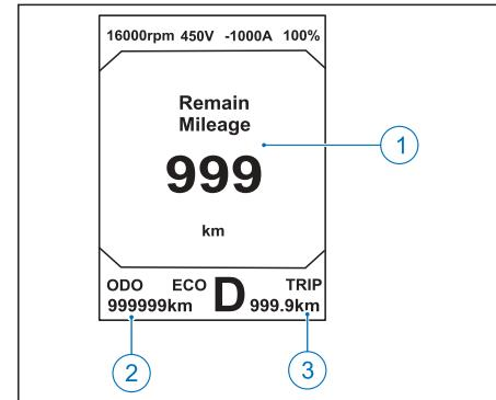
Quando a chave de partida do veículo está na posição ON, o display LCD exibirá as informações de marcha, tensão, corrente, carga da bateria, consumo médio em kW/100km, hodômetro parcial e hodômetro total.
