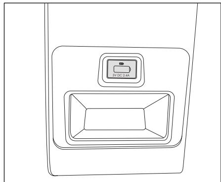
A interface de carregamento USB pode ser utilizado quando o interruptor de partida está na posição “ACC” ou “ON”. A interface de carregamento 5V (2.4A) USB pode ser utilizada para enviar energia a acessórios elétricos, como por exemplo aparelhos celulares.
