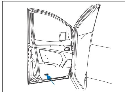
Abra a porta, a luz da porta correspondente irá ligar automaticamente. Quando a porta for fechada, a luz irá desligar automaticamente.
