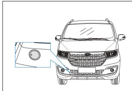
1. O furo do gancho frontal de reboque está localizado no para-choque frontal direito do compartimento do motor.
