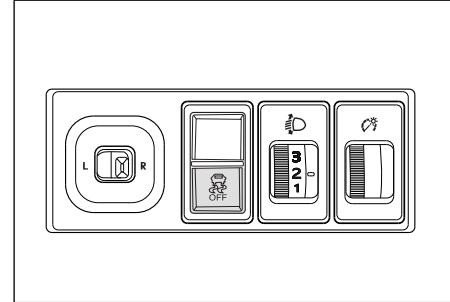
É utilizado para ligar e desligar o sistema do controle de estabilidade do veículo. O interruptor está ligado por padrão de fábrica. Pressione o interruptor para desligar essa função. A lâmpada indicadora do ESC OFF acenderá no painel de instrumentos. Pressione o interruptor novamente para ligar.
