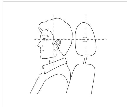
O apoio de cabeça oferece proteção máxima quando o centro do apoio de cabeça está nivelado com a parte superior das orelhas do condutor.
