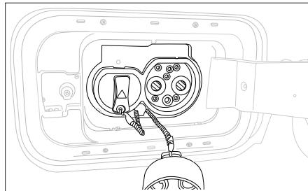
5. Encaixe o conjunto montado (adaptador DC + plugue CC2) no veículo.
