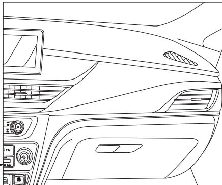
O seu veículo está equipado com um sistema de Air-bag (SRS) com a palavra “SRS Air-bag” nas tampas centrais do volante e no painel frontal do assento do passageiro dianteiro. Em colisões, além da proteção oferecida pelos cintos de segurança, o SRS oferece proteção adicional ao motorista e aos passageiros da frente.
