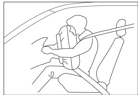
O Air-bag desinfla instantaneamente após inflar. Isso não afetará a linha de visão do motorista ou a habilidade de manipular o volante e outros controles.
