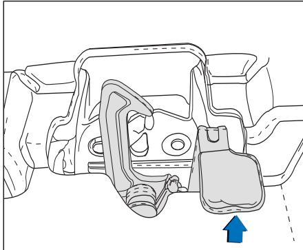
2. Coloque a mão na parte interna da borda frontal do capô e puxe a alavanca de segurança para a esquerda para levantar o capô.
