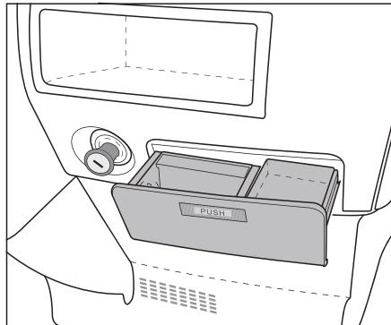
Pressione a tampa do cinzeiro, o cinzeiro saltará automaticamente (remova o cinzeiro ao limpar). Pressione novamente para fechar a tampa do cinzeiro.
