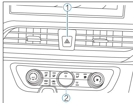
① Interruptor da luz de emergência: pressione o interruptor para ligar a luz de emergência, pressione o interruptor novamente para desligá-lo.
