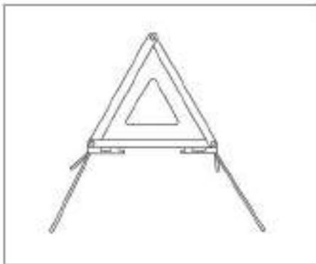
Quando ocorrer um problema enquanto o veículo estiver em movimento, pare lentamente e use o triângulo na caixa de ferramentas para sinalizar a via. Posicione a cerca de 150 metros atrás do seu veículo, e ligue o pisca-alerta
