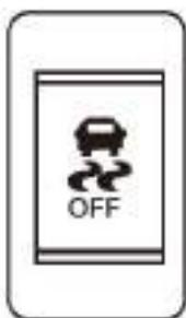
É usado para ligar o controle de estabilidade do veículo. O sistema é ligado toda vez que o veículo for iniciado. Pressione o botão para desligar a função. O computador de bordo exibirá ESC OFF. Para ligar novamente, pressione o botão. O computador de bordo exibirá ESC ON.
