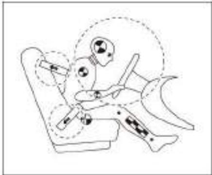
Quando o cinto está afivelado, você está preso ao assento e, consequentemente, ao veículo. Logo, quando houver uma desaceleração do veículo seu corpo será desacelerado pelo cinto de segurança, protegendo seu corpo de um lançamento frontal.
