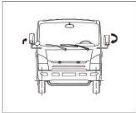
O ajuste do retrovisor externo pode ser feito deslocando o retrovisor para as direções indicadas na figura.
