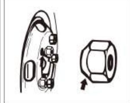
3. Aperte temporariamente as porcas da roda com as rodas levantadas e abaixe o veículo em seguida.
