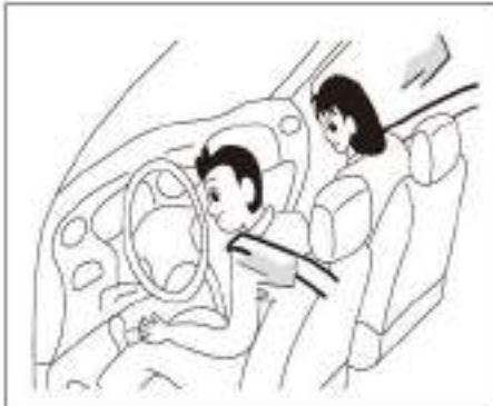
Os cintos de segurança de três pontos do motorista e do passageiro são equipados com pré-tensionadores cujo objetivo é garantir a segurança do motorista e do passageiro dianteiro quando ocorrer uma colisão frontal. O pré-tensionador será ativado simultaneamente com o Airbag SRS. Quando a colisão acontece e os ocupantes do veículo estão inclinados para a frente, o pré-tensionador será bloqueado, prendendo os ocupantes do veículo de forma segura e amortecendo o impacto frontal.
