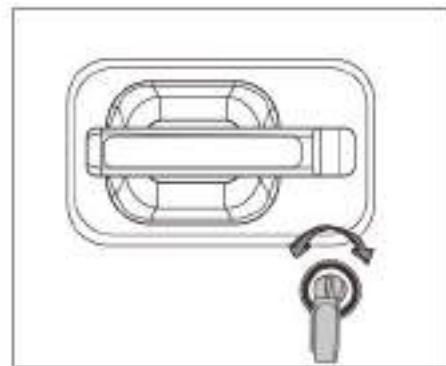
Insira a chave na fechadura da porta e gire-a na direção traseira do veículo para destravar a porta e travar a porta girando-a na direção oposta.
