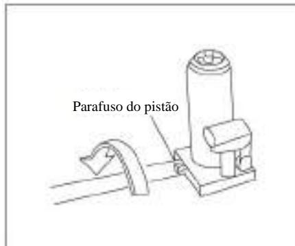
1. Alinhe a extremidade da barra do macaco com o parafuso do pistão.
