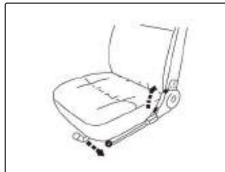
Levante e segure a alavanca na frente do assento para destravar o assento. Deslize o assento até a posição desejada e então solte a alavanca. Então move o assento para trás e para frente para confirmar que está travado adequadamente.
