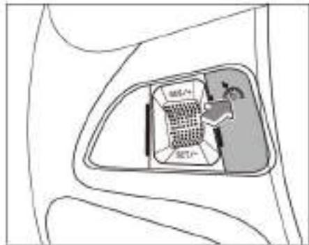
Start: Pressione o interruptor do controle de cruzeiro no volante multifuncional. O indicador de cruzeiro no painel de instrumentos ficará branco. A velocidade da última configuração de cruzeiro será exibida na parte superior esquerda do velocímetro. Acelere até a velocidade necessária (maior que 30 km/h e menor que 90 km/h), opere o botão de controle de cruzeiro, pressione a roda de rolagem na direção SET/-, a velocidade atual será a velocidade de cruzei-
