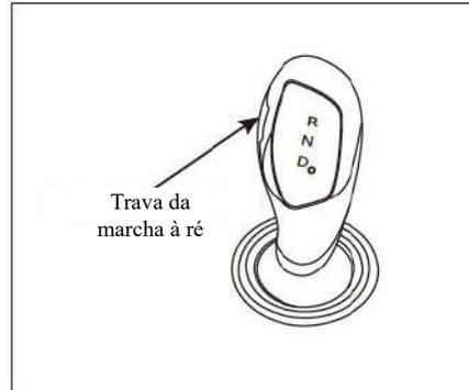
O seletor de marcha é um sistema eletrônico de mudança de marcha com 3 posições: “D” (dirigir), “R” (marcha à ré) e “N” (neutro) e a posição atual do seletor é exibida no painel;
