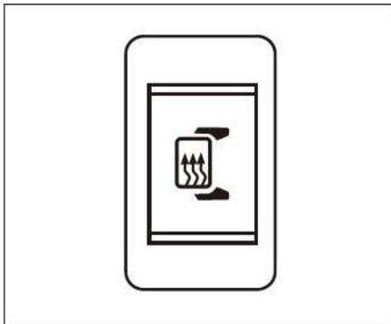
Para remover a umidade que atrapalha a visão nos retrovisores externos, utilize o desembaçador através deste interruptor.
