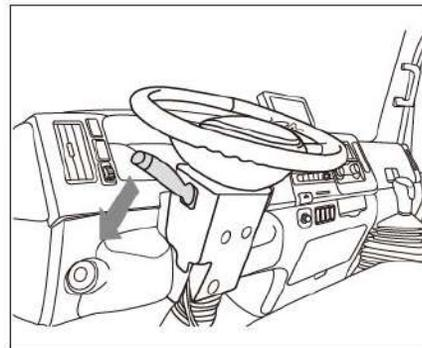
Gire o interruptor na extremidade da alavanca na posição de farol baixo e empurre a alavanca para frente (direção do painel) até ouvir um clique para ligar o farol alto. Puxe a alavanca para trás para voltar para o farol baixo.
