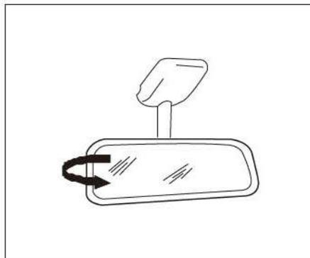
Depois de escolher uma posição de condução confortável, segure o meio do espelho e ajuste o espelho retrovisor para cima e para baixo ou para a esquerda e direita para ver o veículo atrás.
