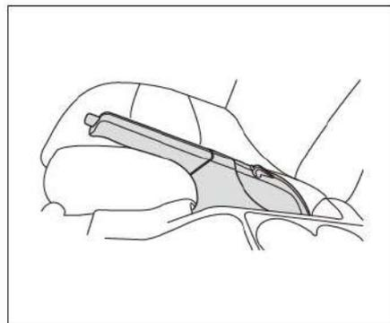
A alavanca do freio de estacionamento está localizada entre os dois assentos dianteiros. Ao estacionar, puxe a alavanca de estacionamento. A luz indicadora do freio de estacionamento no painel de instrumentos acenderá. Para liberar a alavanca de estacionamento, puxe-a para cima levemente, pressione o botão de travamento, e então a abaixe e solte. O indicador de estado de estacionamento apagará.
