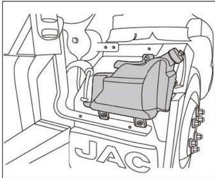
O sistema de arrefecimento é um sistema fechado com pouca perda de fluido. Se o nível do líquido de arrefecimento estiver diminuindo muito, é possível que o veículo tenha vazamentos. Caso aconteça, entre em contato com uma autorizada JAC Motors.
