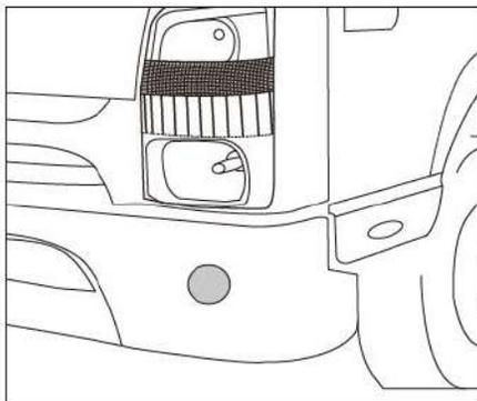
O LED diurno é utilizado para servisto com maior facilidade durante o dia por outros motoristas. Esta luz fica permanentemente ligada quando a chave está na posição ON, e não pode ser desligada manualmente.
