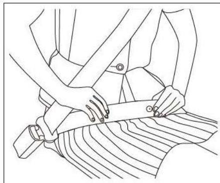
Depois de ajustar o cinto, ele irá expandir automaticamente e contrair para encaixar no seu quadril. Se o cinto de segurança for colocado muito alto e ocorrer um acidente ou frenagem de emergência, o corpo poderá escorregar para fora da parte inferior e causar ferimentos graves.
