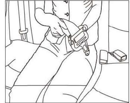
Quando realizar um ajuste no cinto de segurança, mantenha sempre a trava de segurança em um ângulo correspondente à fivela e em seguida ajuste o tamanho do cinto. Pressionar a trava de metal facilita o ajuste.
