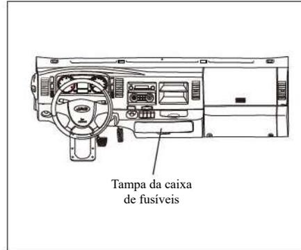
A caixa de fusíveis está localizada na parte inferior do painel. Abra a tampa da caixa de fusíveis para verificar e substituir relés e fusíveis. A tampa pode ser facilmente puxada manualmente, e o mapa de funções dos fusíveis e dos relés é afixado na parte interna da tampa. Ao substituir relés e fusíveis, use um alicate de ponta fina ou um clipe de plástico para retirá-los.
