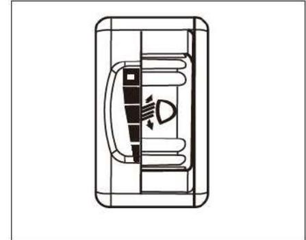
Os interruptores de ajuste de altura dos faróis podem ser usados para ajustar a altura do fecho de luz de acordo com a carga do veículo. A chave deve estar na posição ON e o farol ligado. Vire o anel de ajuste para cima para elevar ou abaixar a altura do fecho do farol.
