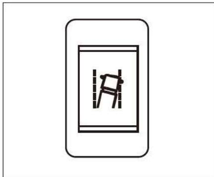
É usado para ligar e desligar a função de aviso de mudança de faixa involuntária. O dispositivo permanece ligado por padrão quando o veículo é iniciado. O computador de bordo exibirá LDWS ON. Pressione o botão para desligar esta função. O computador de bordo exibirá o LDWS OFF após apertar o interruptor. Pressione o interruptor novamente e o dispositivo será ligado.
