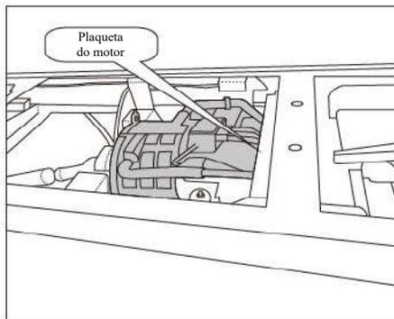
A plaqueta do motor está estampada na tampa traseira do motor. O modelo do motor, tensão, potência, velocidade, torque, grau de proteção, modo de arrefecimento etc. estão indicados nesta plaqueta. A posição da plaqueta do motor é mostrada na figura. O local específico pode ser encontrado pelo usuário para fácil uso e manutenção.
