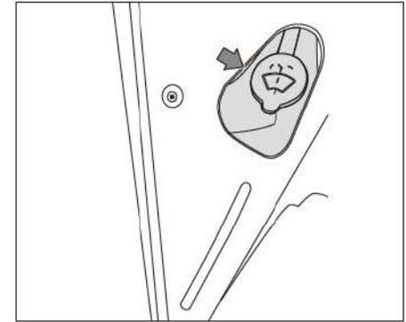
Regularmente, verifique o nível da solução de lavagem de vidro e adicione-o quando necessário. Em condições frias, a solução de lavagem congela e incha, danificando o reservatório do fluido de lavagem. Nunca adicione fluido de lavagem em mais que três quartos do volume.
