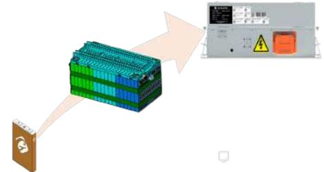
O pack é formado por células do tipo prismática agrupadas em módulos. Cada pack individual possui em seu interior 7 módulos e cada um desses módulos é formado por 36 células prismáticas agrupadas no layout 6P6S.
