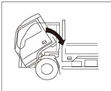
Depois que a cabine descer até um determinado ângulo, a velocidade de descida diminui. Segure o suporte da alça do cabo com a mão esquerda e empurre-o para baixo até que o gancho de travamento prenda o suporte de parada do gancho no chassi.
