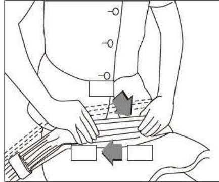
Depois de ajustar o cinto, ele irá expandir automaticamente e contrair para encaixar no seu quadril. Se o cinto de segurança for colocado muito alto e ocorrer acidente ou frenagem de emergência, o corpo poderá escorregar para fora da parte inferior e causar ferimentos graves.
