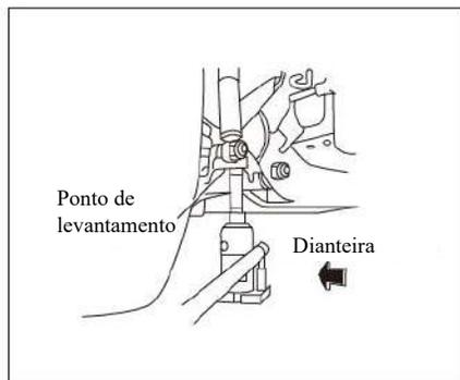
Coloque o macaco no ponto de suporte da barra estabilizadora, como demonstrado na figura.
