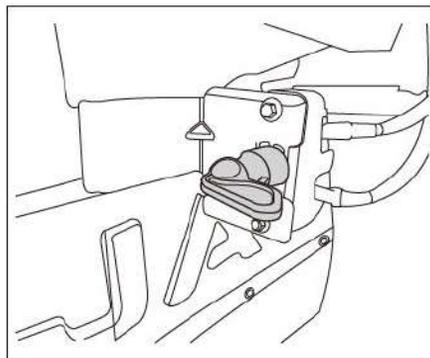
A seta branca no interruptor aponta em "ON", indicando que o interruptor está ligado e o veículo está energizado com baixa tensão.
