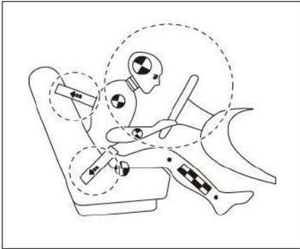
Quando o cinto está afivelado, você está preso ao assento e, conseqüentemente, ao veículo. Logo, quando houver uma desaceleração do veículo seu corpo será desacelerado pelo cinto de segurança, protegendo seu corpo de um lançamento frontal.
