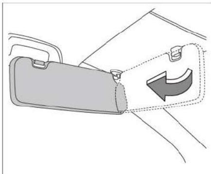
O veículo está equipado com um para-sol que deve ser puxado para baixo para proteger o condutor e o passageiro da luz solar dianteira. Quando houver necessidade de utilizar proteção contra o sol lateral, pode-se desencaixar o para-sol do suporte e girar ele em direção à porta.
