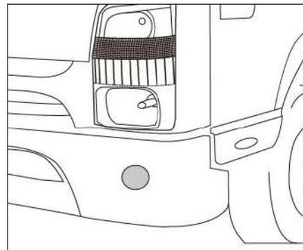
A luz de neblina dianteira auxilia na visibilidade em situações de serração ou neblina, utilizando um fecho curto e baixo de farol. É importante para também ser melhor visto por outros condutores.
