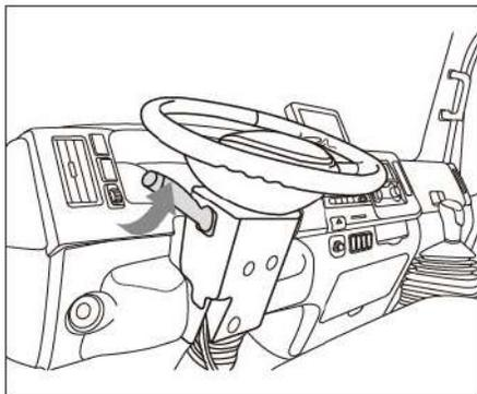
Você pode controlar as luzes girando a extremidade da alavanca. Quando é girado para a posição , a luz de posição, a luz da placa, o painel de instrumento e a luz de fundo dos botões serão acesos. O farol baixo pode ser ligado girando a alavanca para a posição .
