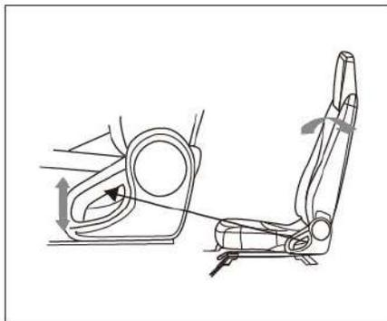
1. Levante a alavanca de ajuste e ajuste o encosto para a posição desejada.
