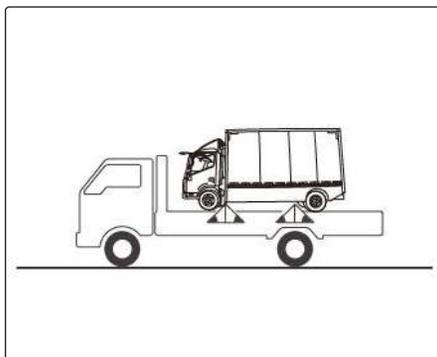
A melhor forma de transportar o seu veículo é em plataforma plana basculante, como mostrado na figura.
