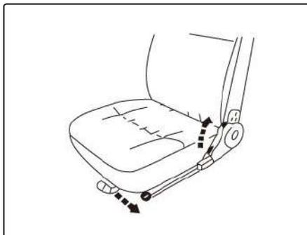
Levante e segure a alavanca na frente do assento para destravar o assento. Deslize o assento até a posição desejada e então solte a alavanca. Então mova o assento para trás e para frente para confirmar que está travado adequadamente.
