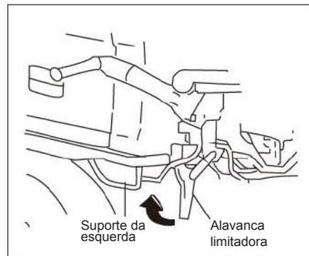
Após o destravamento da alavanca de abertura, com mão esquerda, segure o suporte e utilize a alavanca limitadora para liberar o sistema. Empurre a cabine para cima e ela irá bascular automaticamente.
