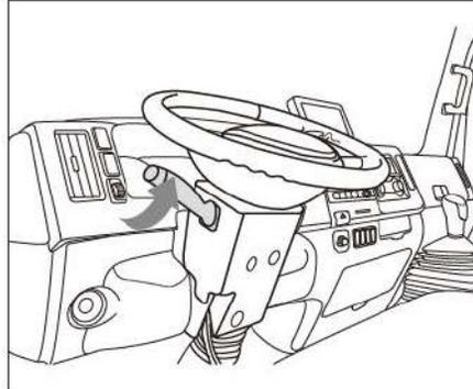
O interruptor das luzes de neblina está localizado no interruptor combinado. Gire o interruptor da extremidade para a posição e em seguida gire o interruptor no meio do interruptor combinado na posição para ligar as luzes de neblina dianteiras. O indicador da luz de neblina dianteira no painel de instrumentos acende. Para utilizar a luz de neblina frontal a chave deve estar na posição ON e os faróis devem estar ligados.
