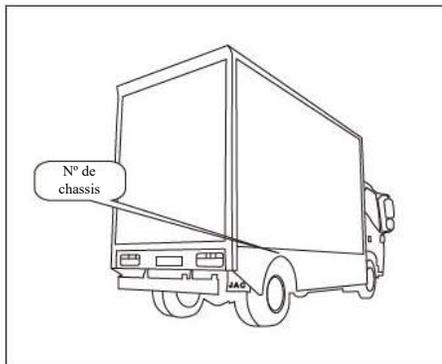
O número do chassi é a identificação do veículo. O número do chassi em caminhões está localizados no lado externo da viga do chassi na extremidade traseira direita (alguns veículos podem ter impressos no chassi atrás da roda dianteira direita).
