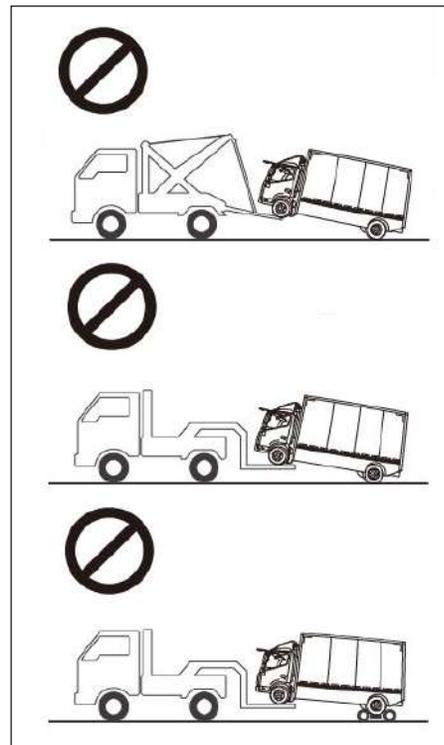
Não reboque o veículo mantendo o eixo traseiro no solo. As rodas em contato com o solo poderá gerar energia e danificar o sistema.
