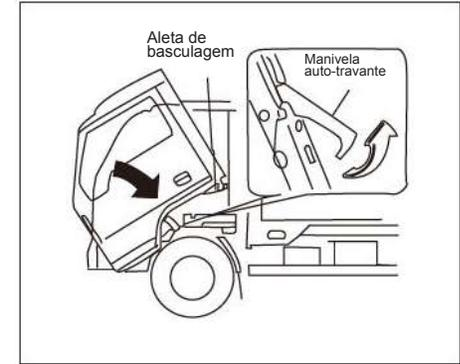
Use a mão esquerda para segurar o suporte da manopla de segurança e abra a manivela de travamento automático com a mão direita para cima e para trás. A cabine desce automaticamente com o seu próprio peso.
