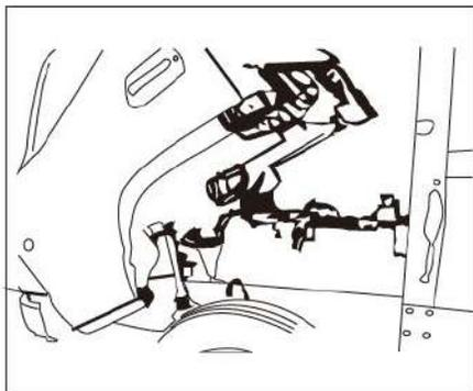
O dispositivo de basculagem da cabine está localizado fora da cabine, logo atrás do lado esquerdo do motorista. A cabine pode ser movimentada em 40 graus para facilitar a manutenção. Antes de iniciar o processo as portas deverão estar fechadas e não devem ser deixados objetos soltos dentro da cabine.
