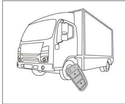
Com a chave, várias funções podem ser realizadas, como travar/destravar as portas, localizar o veículo\*, destravar o baú\* e subir e descer os vidros\*.
