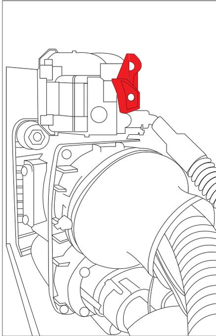
É utilizado em emergências ou em último caso para interromper a recarga quando não for possível interromper no carregador, ou quando há uma falha no sistema ou a trava da porta da interface de carregamento e o botão de abertura estejam danificados. Nesse caso, você deverá abrir de forma manual. Gire para cima o dispositivo de abertura de emergência como mostra na imagem e retire o plugue de carregamento.
