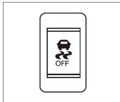
É usado para ligar o controle de estabilidade do veículo. O sistema é ligado toda vez que o veículo for iniciado. Pressione o botão para desligar a função. O computador de bordo exibirá ESC OFF. Para ligar novamente, pressione o botão. O computador de bordo exibirá ESC ON.
