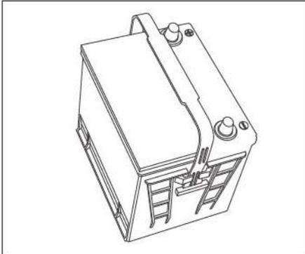
O veículo é equipado com uma bateria de chumbo-ácido de 12 V livre de manutenção. Se você precisar substituí-la, favor usar as mesmas especificações das baterias de chumbo-ácido encontradas originalmente no veículo.
