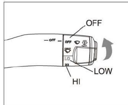
Mova o interruptor na extremidade direita para que o lavador do para-brisa dianteiro entre em funcionamento.
