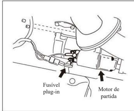
Se os faróis ou outros dispositivos elétricos não funcionarem, mas o fusível estiver normal, verifique o fusível de plug-in. Se o fusível do plug-in estiver queimado, ele deverá ser substituído. Certifique-se de usar fusíveis originais JAC na substituição. Não instale um jumper com fio mesmo como uma medida temporária pois isso poderá causar grandes danos ou até um incêndio.
