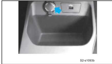
O veículo está equipado com uma tomada de energia para acessórios. Pode-se inserir acessórios de dispositivos eletrônicos através da tomada de acessórios. A tomada de acessórios pode ser utilizada apenas com o interruptor de ignição nas posições "ACC" ou "ON".
