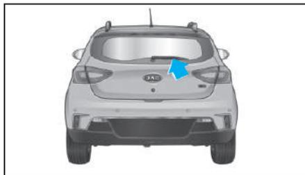
Para substituir a palheta do limpador traseiro, eleve-a e desmonte-a para substituí-la.
