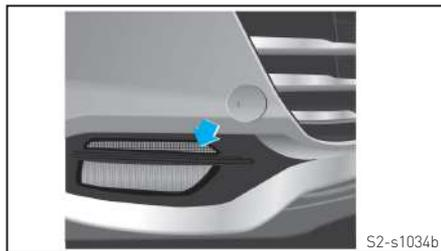
A lanterna e o farol de neblina dividem um alojamento que está localizado abaixo da lâmpada do farol de neblina. As lanternas diurnas são utilizadas para alertar pedestres e veículos enquanto o veículo passa através de túneis ou áreas escuras durante o dia. As lanternas podem ser ligadas apenas com o motor ligado e o freio de estacionamento liberado.
