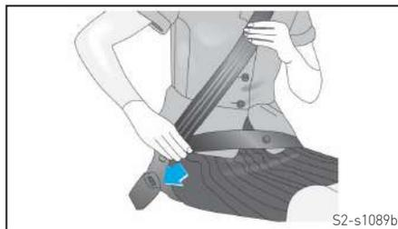
Puxe o cinto de segurança da caixa do tensionador e insira a fivela de metal em sua base. Um som de "clique" será ouvido se a fivela de metal for travada. Após ajustar o cinto de segurança no abdômen, o cinto de segurança será tracionado automaticamente para se fixar ao corpo.
