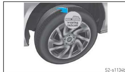
Verifique o indicador de desgaste para avaliar a necessidade de substituição do pneu. Quando a superfície do pneu estiver abaixo de 2,2 mm, a marca de indicação de desgaste aparece.
