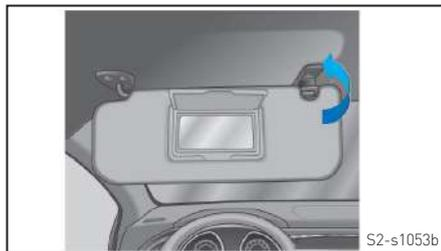
Dois quebras-sol estão instalados no veículo para bloquear a luz do sol frontal ou lateral do lado do motorista e do passageiro dianteiro. Para reduzir a incidência do sol ou bloquear a luz do sol, abaixe o quebra-sol. Para bloquear a luz do sol na lateral, abra o quebra-sol e gire-o para a esquerda (lado do motorista) ou para a direita (lado do passageiro dianteiro).
