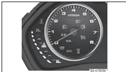
O tacômetro mostra os dados de RPMs do motor, a fim de proteger o motor, não conduza quando o ponteiro do tacômetro estiver na zona vermelha. Evite altas rotações durante o período de condução. O ponto de partida da zona vermelha do tacômetro depende do modelo do motor.
