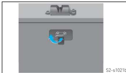
1. Abaixar o banco traseiro, e remover a trava do porta-malas dentro do veículo para abrir a placa de acabamento da maçaneta.
