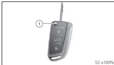
Na compra do veículo, duas chaves são fornecidas juntamente com o veículo. O uso de qualquer chave pode travar e destravar o veículo através do controle remoto. Guarde uma chave em um local seguro como reserva no caso da chave ser trancada dentro do veículo. Para desdobrar a chave, pressione o botão (1). Para dobrar a chave, pressione o botão (1) e dobre a chave manualmente.
