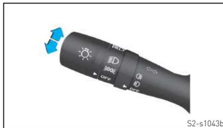
A luz indicadora de direção funciona apenas com o interruptor de ignição ligado.
