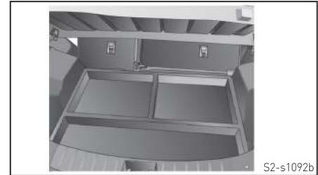
Para ajudá-lo a armazenar objetos pequenos (espessura inferior a 70mm) e manter a limpeza interna do veículo, o separador de objetos foi equipado na parte inferior da placa de cobertura de pneu sobressalente. Você pode levantar a placa de cobertura pushing cordas na parte do meio e armazenar seus objetos no separador no separador.
