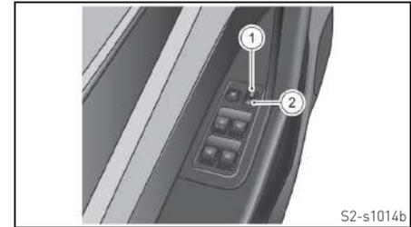
Botão de controle do travamento da porta na porta do motorista pode controlar o travamento das quatro portas. Pressione a parte da frente do botão (1) para travar as quatro portas, e pressione a parte traseira (2) para destravá-las.
