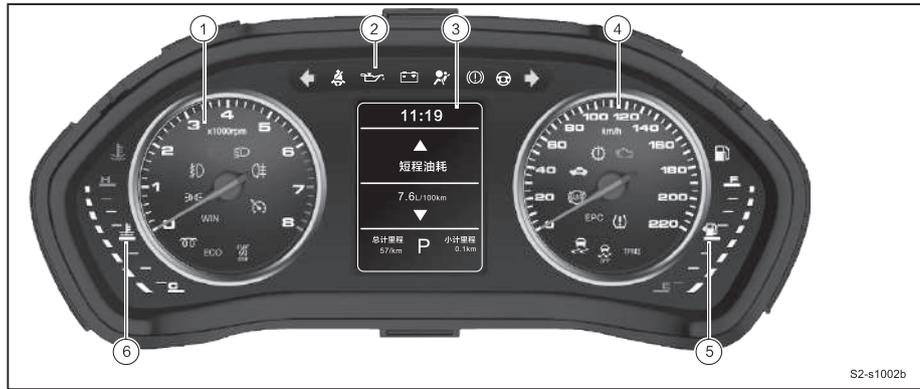
1. Tacômetro - 2. Luz de indicação - 3. Tela de LED - 4. Velocímetro - 5. Indicador de combustível
