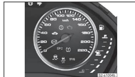
O velocímetro indica a velocidade atual com a unidade km/h.
