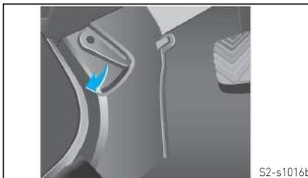
A alavanca de destravamento do capô está localizada na parte inferior esquerda do painel de instrumentos do motorista. A operação de abertura e fechamento do capô é a seguinte:
