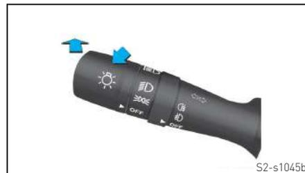
Gire o interruptor na extremidade da alavanca do interruptor combinado das luzes indicadoras de direção para a posição e empurre a alavanca do interruptor combinado para frente até ouvir o som de "clique" ligando o farol alto. Quando o farol alto é aceso, a luz indicadora do farol alto no painel também irá acender. Para voltar para o farol baixo, puxe a alavanca para trás.
