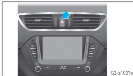
Há uma marca triangular no interruptor do pisca alerta, como indicado na figura acima. O pisca alerta pode ser utilizado com o interruptor de ignição desligado. Você pode utilizar o pisca alerta nas seguintes condições:
