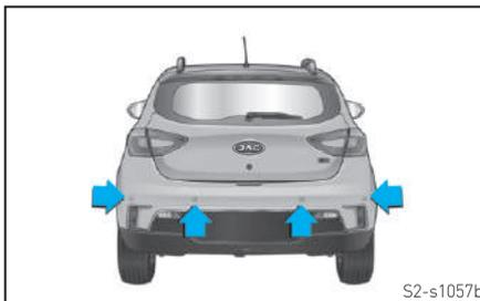
O sistema do sensor de estacionamento fornece ao motorista uma assistência durante manobras de baliza. Quando o sensor detecta um obstáculo em uma distância de 150 cm da dianteira\* ou da traseira\* do veículo, o alarme do sensor emite um som para advertir o motorista. O sistema apenas auxilia no sentido para frente quando o interruptor "Parking" localizado ao lado esquerdo do volante do motorista está ativado, monitorando a distância e detectando objetos. Certifique-
