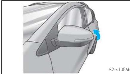
Para dobrar o retrovisor externo empurre-o na direção do veículo. É recomendado que o retrovisor externo seja dobrado quando for necessário estacionar o veículo em lugares estreitos.
