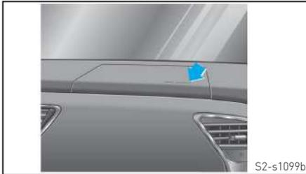
O veículo está equipado com o sistema de proteção suplementar, identificado pela marca "SRS AIRBAG" na capa do airbag do volante de direção e no painel de instrumentos em frente ao banco do
