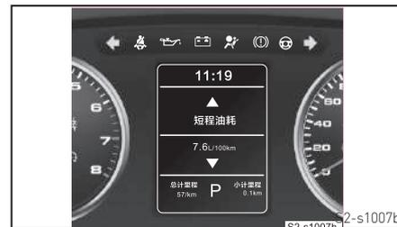
O computador de bordo é um LED controlado por uma ECU para indicar todos os tipos de informação de condução como o relógio, odômetro parcial, odômetro total, consumo médio de combustível etc, a partir do momento em que o interruptor da ignição é ligado. Após desconectar a bateria, todas as informações armazenadas serão zeradas, exceto o odômetro total.
