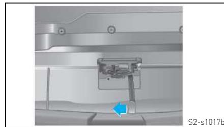
Antes de fechar o capô, levante-o ligeiramente, solte a haste de apoio do capô e encaixe-a em sua presilha. Abaix o capô lentamente, e deixe-o cair livremente a uma distância de aproximadamente 30 cm da trava, para travá-lo. Então, levante ligeiramente o capô para verificar se o capô está fechado e travado. Se o capô não estiver fechado e travado, repita as etapas acima.
