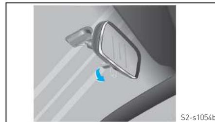
Posição normal: pressione a alavanca de controle anti-ofuscamento em direção à frente do veículo.
