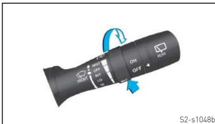
Quando a alavanca do interruptor combinado está na posição INT, a velocidade do limpador pode ser ajustada rotacionando o botão indicado acima.
