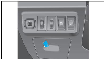
Para evitar danificar os circuitos devido à curto circuito ou sobrecarga, cada circuito possui um fusível. Se o fusível estiver queimado e o fusível que o substituir queimar novamente após um curto período de uso,
