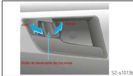
Primeiro, gire o interruptor de ignição para a posição "LOCK", retire a chave, pressione o botão de travamento da maçaneta. Quando a porta for fechada pelo exterior do veículo, ela será travada.
