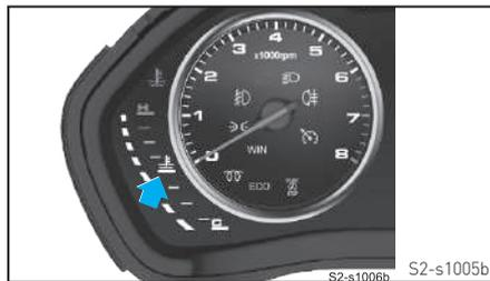
O indicador TEMP indica a temperatura do líquido de arrefecimento do motor quando o interruptor de ignição é ligado.
