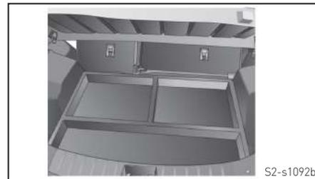
Para ajudá-lo a armazenar objetos pequenos (espessura inferior a 70mm) e manter a limpeza interna do veículo, o separador de objetos foi equipado na parte inferior da placa de cobertura de pneu sobressalente. Você pode levantar a placa de cobertura pushing cordas na parte do meio e armazenar seus objetos no separador no separador.
