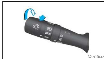
Gire o interruptor na extremidade da alavanca de controle das luzes indicadoras de direção para controlar a iluminação. Quando o interruptor é girado para a posição , as lanternas, a luz da placa de licença, a luz de fundo do painel de instrumentos e do console central são ligadas. Quando o interruptor é girado para a posição , os faróis são ligados.
