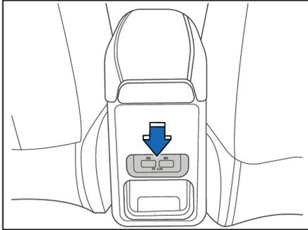
O veículo está equipado com uma tomada de energia para acessórios. Pode-se inserir acessórios de dispositivos eletrônicos através da tomada de acessórios. A tomada de acessórios pode ser utilizada apenas com o interruptor de ignição nas posições ACC ou ON.
