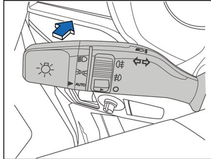
Gire o interruptor em forma de barril na extremidade do interruptor combinado para a posição e empurre a alavanca do interruptor combinado (para frente) até ouvir um clique. O farol alto estará aceso. Enquanto o farol alto estiver aceso, o indicador do farol alto no painel de instrumentos também acenderá. Se quiser voltar para o farol baixo, puxe a alavanca do interruptor combinado para trás.
