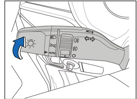
Você pode controlar a intensidade da luz do farol girando o interruptor em forma de barril na extremidade do interruptor combinado. Quando o interruptor em forma de barril é girado para a posição,
