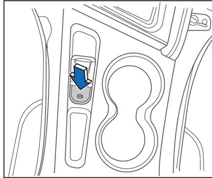
O sistema Auto Hold segura o veículo tanto na subida, como na descida, o que permite que o motorista tire o pé do freio e o veículo não se movimente em qualquer direção. Ele só libera o freio no momento em que o motorista encostar o pé no acelerador. Abrir a porta lateral do motorista, remover o cinto de segurança ou desligar o motor desligará o sistema automaticamente. Se as situações acima ocorrerem quando o veículo estiver parado, o freio de estacionamento
