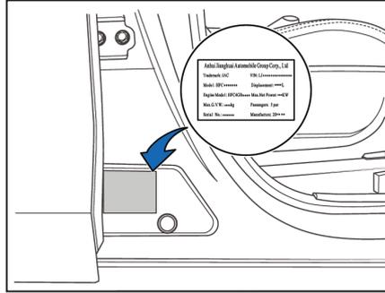
A plaqueta do veículo está na parte inferior da coluna direita B e inclui as seguintes informações: marca/número de identificação do veículo/modelo do veículo/motor/modelo do motor/potência líquida máxima do motor/peso máximo permitido/número de passageiros/ número de fabricação/data de fabricação.
