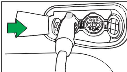
③ Quando o carregamento for concluído o indicador de carga piscará acompanhado de um "bip". Retire o plugue da tomada conectada a sua residência, pressione o botão de desbloqueio na Smart key, aguarde alguns instantes e remova o plugue do veículo. Guarde o cabo no seu case.
