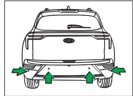
O sistema do sensor de estacionamento é baseado no princípio da medição de distância ultrassônica do sensor de estacionamento para determinar se há obstáculos atrás do veículo e para indicar a distância do obstáculo mais próximo.
