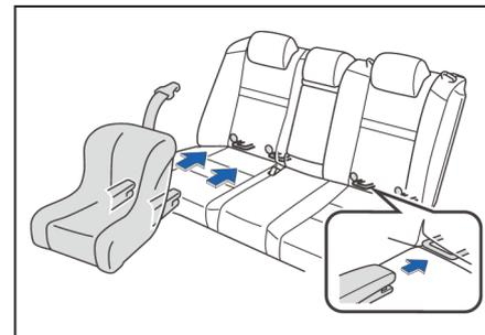
3. Deslize o mecanismo de trava da cadeira para crianças até o ponto de fixação inferior, para garantir que os dois mecanismos de fixação ISOFIX foram corretamente fixados.
