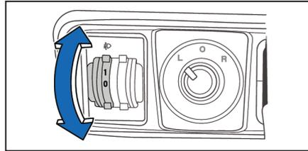
A distância da iluminação dos faróis baixos pode ser ajustada na cabine e o interruptor de ajuste está localizado no painel do interruptor do instrumento no lado esquerdo do volante. A distância da iluminação pode ser ajustada ajustando o interruptor para se adaptar às diferentes atitudes de inclinação do veículo causadas por diferentes pesos do veículo. À medida que a carga aumenta, a distância de iluminação do farol baixo diminui.
