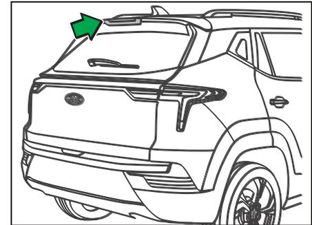
A lâmpada de freio elevada é usada para complementar a indicação e o aviso da lâmpada de freio.
