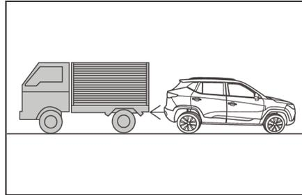
Se os ruídos das buzinas, motores, escapamentos e outros veículos se aproximarem demais do sensor de estacionamento, o sistema pode falhar.
