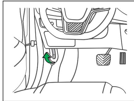
2. Estenda a mão para alcançar dentro da borda frontal do capô do motor e puxe a alavanca de segurança para a esquerda para levantar o capô.
