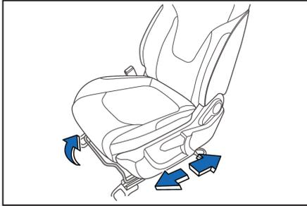
Puxe e segure a alavanca para soltar o mecanismo de travamento do banco. Deslize o banco para a posição desejada, em seguida, solte a alavanca. Em seguida, tente mover o banco e verifique se ele está travado.
