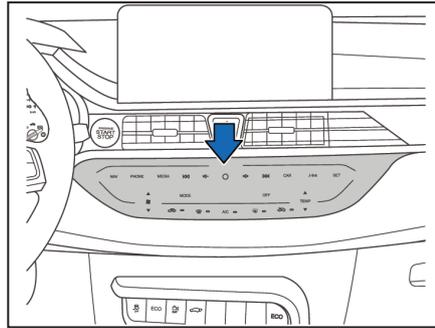
O dispositivo do A/C pode aquecer, resfriar e remover a umidade do ar dentro do veículo. Sua eficiência de trabalho será máxima quando os vidros e o teto solar estiverem fechados. Quando o calor é acumulado dentro do veículo, a ventilação pode acelerar o resfriamento do ar.
