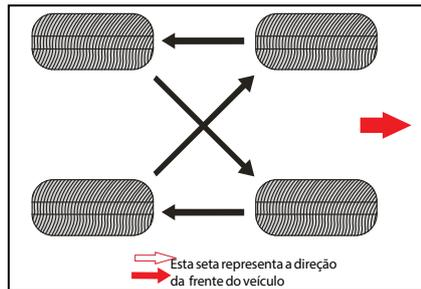
Após as rodas serem substituídas, as pressões de ar dos pneus dianteiro e traseiro são ajustadas de acordo com a pressão do pneu. Certifique-se de que todas as porcas da roda estão corretamente apertadas.
