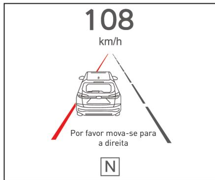
A interface de aviso do painel de instrumentos é mostrada na figura acima (o veículo se desvia da linha da pista esquerda). Quando o veículo se desvia da faixa detectada pelo sistema de alerta de mudança de faixa, o módulo de instrumento combinado mostra a interface de aviso e envia um som de aviso de saída da faixa, e a frequência do som é 2 vezes por segundo.
