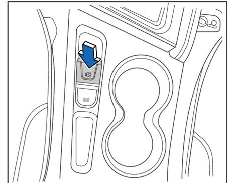
Quando estacionar, pressione o botão EPB, o indicador de status de estacionamento (⚠) acende. Solte o freio de estacionamento eletrônico. Ligue o interruptor de alimentação e o coloque no estado ON.
