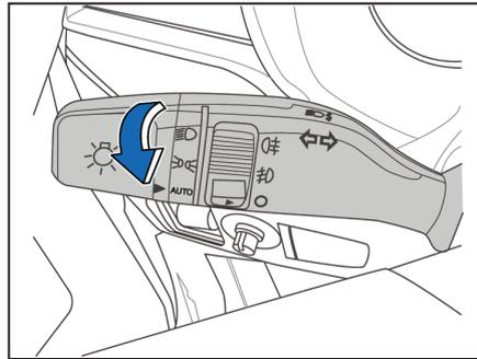
Quando a chave combinada estiver no modo AUTO, o sistema de controle automático de luz será ativado e controlará o farol alto, a luz de posição e a luz da lanterna.
