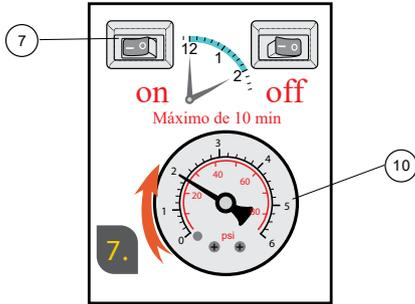
13. O pneu deve ser inflado dentro de 10 minutos para um valor que esteja entre 29 psi (200 kPa) e 41 psi (280 kPa) no máximo. Feche o compressor de ar e leia a pressão do pneu exibida no medidor de pressão 10, se for maior que 29 psi (200 kPa), está dentro do recomendado, siga essas etapas para desconectar:
