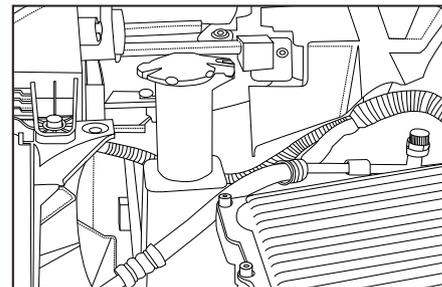
Verifique o nível da solução de lavagem de vidro regularmente e adicione-o em tempo hábil. Em climas frios, a solução de lavagem congela e incha, danificando o reservatório do fluido de lavagem. É proibido adicionar fluido de lavagem em mais que três quartos do volume.
