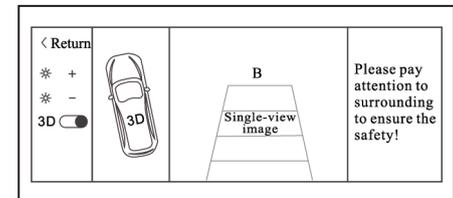
Quando a exibição panorâmica 3D for mostrada e a alavanca de mudança de marchas for engatada na marcha à ré, pressione o botão esquerdo para mudar a tela para a exibição panorâmica 3D traseira esquerda e a imagem de vídeo traseira monocanal mais a linha auxiliar estática para marcha à ré, e todo o veículo avança. Quando a alavanca de mudança de marchas é retirada da posição de marcha à ré, a tela retorna à exibição panorâmica 3D anterior.
