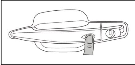
1. Aproxime a chave do veículo e pressione o interruptor localizado na maçaneta da porta dianteira esquerda.
