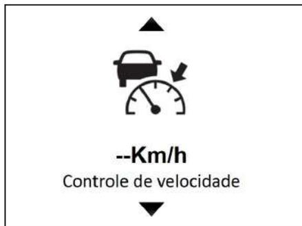
A velocidade do controle de cruzeiro (Cruise Control Setting) mostrará a velocidade do veículo definida pelo condutor. A velocidade pode ser definida através do botão do controle de cruzeiro. Caso não esteja ativado, será exibido na tela "--- km/h".
