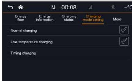
1.3 - Selecione “Timing charging” em seguida toque em “Charging by battery” e escolha o limite de carga SOC de sua preferência 80% ou 100%
