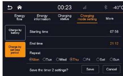
2.3 - Gire a chave para LOCK ou pode retirá-la do veículo, em seguida, pressione o “Botão de carga temporizada” A luz indicadora de carga irá desaparecer. O botão deve ser pressionado após cada configuração do modo de de carga temporizada.
