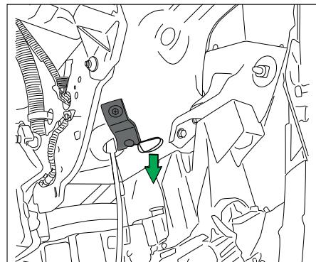
Essa função é utilizada quando o plugue de carregamento trava na tomada do veículo. O cabo de destravamento manual está localizado no lado esquerdo do cofre do motor, logo atrás do farol.
