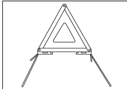
Quando o seu veículo sofrer uma falha durante a condução, por favor conduza-o devagar para um local seguro e coloque o triângulo de emergência a 150 m da extremidade traseira do veículo, em seguida ligue a luz do pisca alerta.
