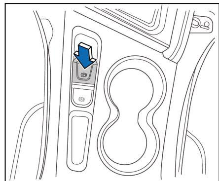
Quando estacionar, pressione o botão EPB, o indicador de status de estacionamento (①) acende. Solte o freio de estacionamento eletrônico. Ligue o interruptor de alimentação e o coloque no estado ON.
