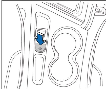
O sistema Auto Hold segura o veículo tanto na subida, como na descida, o que permite que o motorista tire o pé do freio e o veículo não se movimente em qualquer direção. Ele só libera o freio no momento em que o motorista encostar o pé no acelerador. Abrir a porta lateral do motorista, remover o cinto de segurança ou desligar o motor desligará o sistema automaticamente. Se as situações acima ocorrerem quando o veículo estiver parado, o freio de estacionamento
