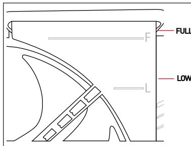
A temperatura do radiador deve ser a mesma que a temperatura ambiente. Se o nível de líquido cai abaixo do mínimo "L" adicione líquido até o nível estar entre "L" [LOW] e "F" [FULL].
