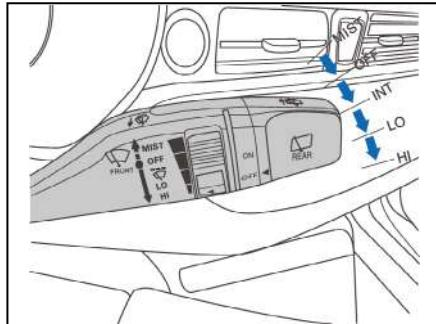
O interruptor combinado direito é utilizado para controlar o mecanismo de limpeza dos vidros.
