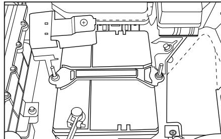
O veículo é equipado com uma bateria de chumbo-ácido de 12V livre de manutenção. Se você precisar substituir, favor usar as mesmas especificações da bateria original.
