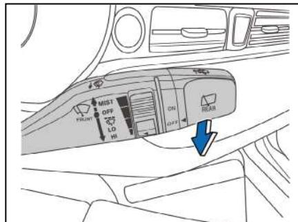
Puxe o interruptor do limpador para a direção do condutor e o lavador pulverizará água continuamente enquanto o limpador estiver funcionando em baixa velocidade. Isto parará quando você soltar o interruptor do limpador.
