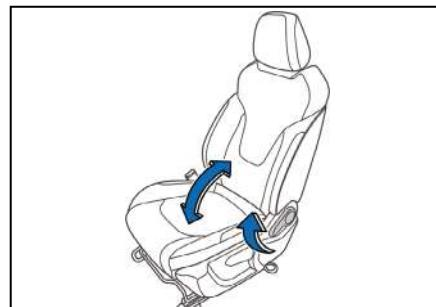
O seu veículo está equipado com uma alavanca manual para ajuste do ângulo do encosto do banco, localizado na parte externa do banco.
