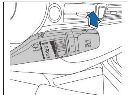
Empurre o interruptor do limpador traseiro para frente e o lavador manterá a pulverização de água enquanto o limpador estiver funcionando em baixa velocidade. O mesmo irá parar quando você soltar o interruptor do limpador.
