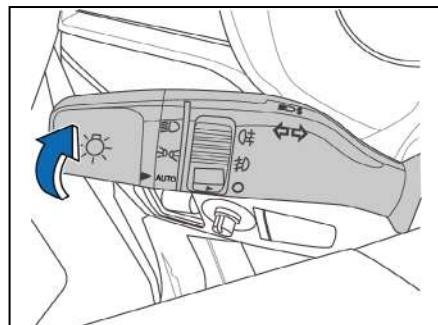
Você pode controlar a intensidade da luz do farol girando o interruptor em forma de barril na extremidade do interruptor combinado. Quando o interruptor em forma de barril é girado para a posição, ~~DE~~, a luz de posição, a luz da placa de licença, a luz
