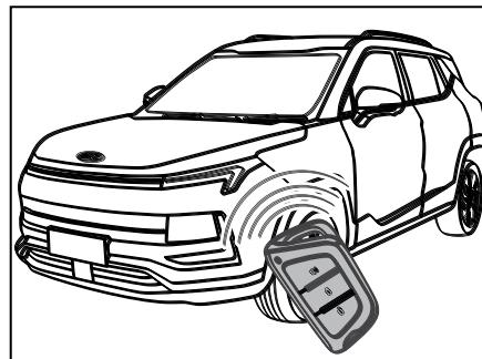
Com a chave do controle remoto, várias funções podem ser realizadas, como travar/destravar o veículo, localizar o veículo, destravar o porta-malas, subir e descer os vidros\* etc.
