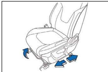
Puxe e segure a alavanca para soltar o mecanismo de travamento do banco. Deslide o banco para a posição desejada, em seguida, solte a alavanca. Em seguida, tente mover o banco e verifique se ele está travado.
