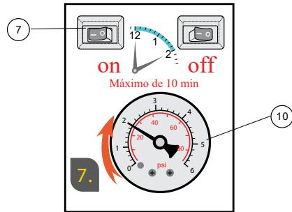
13.0 O pneu deve ser inflado dentro de 10 minutos para um valor que esteja entre 29 psi (200 kPa) e 41 psi (280 kPa) no máximo. Feche o compressor de ar e leia a pressão do pneu exibida no medidor de pressão ⑩, se for maior que 29 psi (200 kPa), está dentro do recomendado, siga essas etapas para desconectar:
