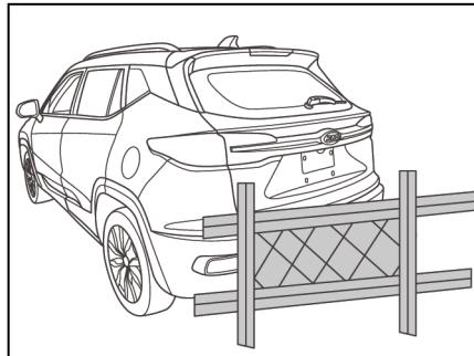
O sensor de estacionamento não pode detectar fios de ferro, cabos, redes de bloqueio e outras redes.
