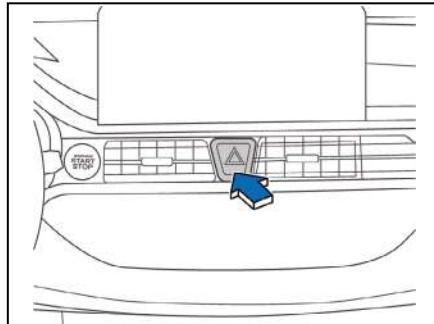
Uma marca de triângulo no interruptor da luz do pisca-alerta indica-o, como exibido na figura acima.
