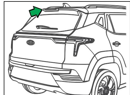
A lâmpada de freio elevada é usada para complementar a indicação e o aviso da lâmpada de freio.
