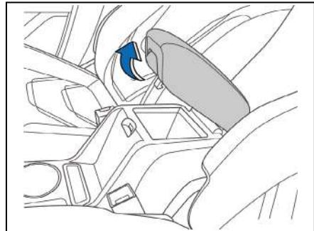
Puxe a fivela para abrir a caixa do apoio de braço, empurre o apoio de braço para fechá-lo. A caixa do apoio de braço desliza ao ser empurrada para frente.
