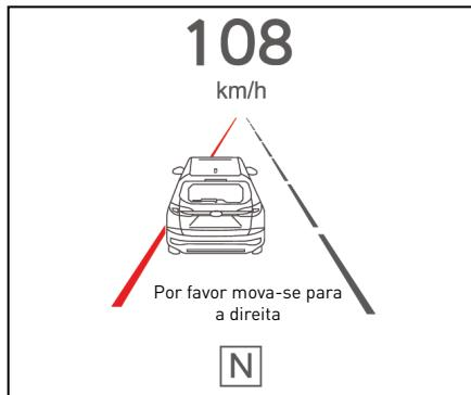
A interface de aviso do painel de instrumentos é mostrada na figura acima (o veículo se desvia da linha da pista esquerda). Quando o veículo se desvia da faixa detectada pelo sistema de alerta de mudança de faixa, o módulo de instrumento combinado mostra a interface de aviso e envia um som de aviso de saída da faixa, e a frequência do som é 2 vezes por segundo.
