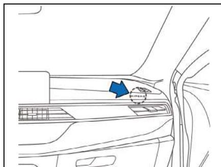
O seu veículo está equipado com um sistema de proteção suplementar (SRS) com as palavras "AIRBAG" na tampa da buzina central do volante e no painel frontal do banco do passageiro da frente. Em colisões, além da proteção oferecida pelos cintos de segurança, o SRS oferece proteção adicional ao motorista e passageiro da frente.
