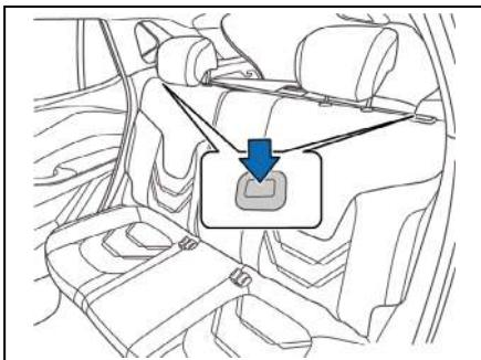
Há um botão de desbloqueio no encosto, e o encosto pode ser desbloqueado pressionando este botão e ele pode ser dobrado para frente depois de ser desbloqueado.
