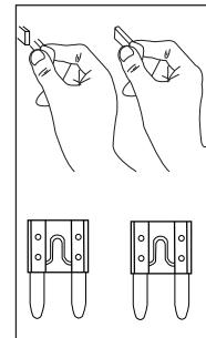
Se qualquer equipamento elétrico não operar, verifique os fusíveis na caixa de fusíveis.
