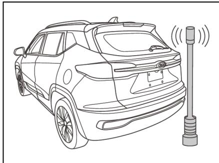
Se o veículo estiver equipado com um rádio ou antena de alta frequência, ou se houver um rádio ou antena de alta frequência sendo usado nas proximidades, o sistema do sensor de estacionamento pode falhar.
