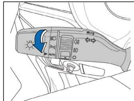
Quando a chave combinada estiver no modo AUTO, o sistema de controle automático de luz será ativado e controlará o farol alto, a luz de posição e a luz da lanterna. Quando a visibilidade externa é baixa, como durante o pôr do sol, a noite ou ao entrar em túnel, o sensor de luz acende o farol, a luz de posição e a luz da lanterna. Quando a visibilidade externa é clara, essas luzes se apagam automaticamente.
