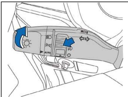
O interruptor das luzes de neblina está localizado na alavanca do interruptor combinado esquerdo. Quando o interruptor da extremidade da alavanca é girado para a posição, luz de posição ou **D**, você pode girar o botão central do interruptor combinado para a posição de farol de neblina dianteiro ou para a posição de lanterna de neblina traseira. No momento em que as luzes de neblina acendem, a luz indicadora do farol de neblina também acenderá no painel. Quando o interruptor é
