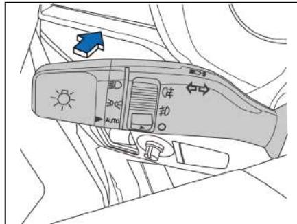
Gire o interruptor em forma de barril na extremidade do interruptor combinado para a posição  **$\text{H}D$**  e empurre a alavanca do interruptor combinado (para frente) até ouvir um clique. O farol alto estará aceso. Enquanto o farol alto estiver aceso, o indicador do farol alto no painel de instrumentos também acenderá. Se quiser voltar para o farol baixo, puxe a alavanca do interruptor combinado para trás.
