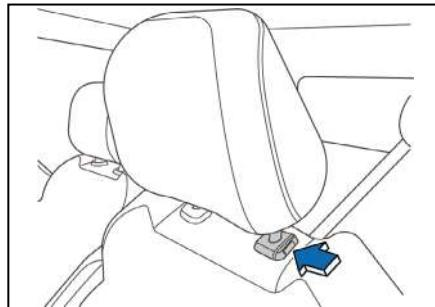
Ajuste a altura do encosto de cabeça e faça a parte superior se aproximar de sua cabeça. O encosto de cabeça pode reduzir a probabilidade do pescoço lesionar.
