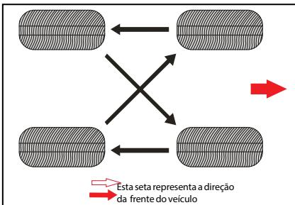
Após as rodas serem substituídas, as pressões de ar dos pneus dianteiro e traseiro são ajustadas de acordo com a pressão do pneu. Certifique-se de que todas as porcas da roda estão corretamente apertadas.
