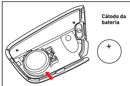
5. Siga a sequência oposta da desmontagem para a montagem.
