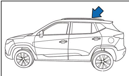
Se o veículo for equipado com rack de teto, é possível fixar objetos no teto do veículo.
