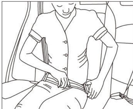
Para encurtar o cinto, puxe a ponta livre do cinto para cima para colocar no comprimento desejado. Coloque uma presilha de ajuste para prender o excesso livre do cinto.
