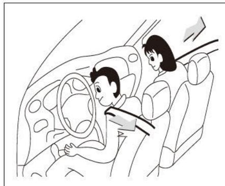
Os cintos de segurança de três pontos do motorista e do passageiro são equipados com pré-tensionadores cujo objetivo é garantir a segurança do motorista e do passageiro dianteiro quando ocorrer uma colisão frontal. O pré-tensionador será ativado simultaneamente com o Air-bag SRS. Quando a colisão acontece e os ocupantes do veículo estão inclinados para a frente, o pré-tensionador
