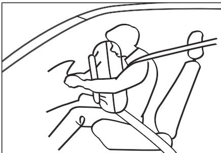
O Air-bag desinfla instantaneamente após inflar. Isso não afetará a linha de visão do motorista ou a habilidade de manipular o volante e outros controles.
