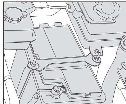
Se a carga da bateria 12 V estiver baixa o veículo não fica em READY e não carrega a bateria de tração.
