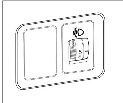
Após acender os faróis do veículo, a altura de irradiação da luz do farol pode ser ajustada girando o interruptor de ajuste elétrico do farol. À medida que a regulagem aumenta de 1 até 5, a altura do farol diminui gradualmente.
