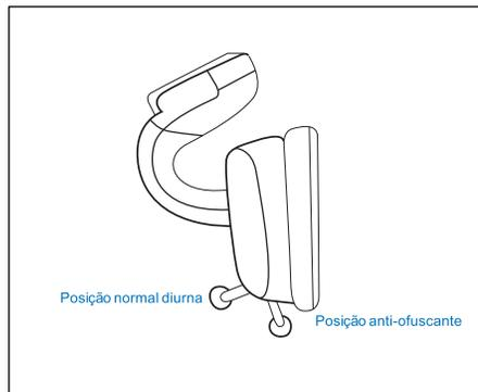
O veículo está equipado com um espelho retrovisor interno. Para ajustá-lo, segure o meio do espelho e ajuste o espelho retrovisor para cima e para baixo ou para a esquerda e direita para ver o veículo atrás. Anti-escurecimento: o retrovisor conta com uma aba inferior para ajuste anti-escurecimento. A posição da aba em direção ao painel coloca o retrovisor em modo anti-escurecimento. Retorne a aba para a direção do para-brisa para o modo normal.
