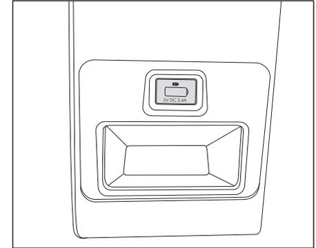
A interface de carregamento USB pode ser utilizada quando o interruptor de partida está na posição “ACC” ou “ON”. A interface de carregamento 5V (2.4A) USB pode ser utilizada para enviar energia a acessórios elétricos, como por exemplo aparelhos celulares.
