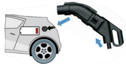
5. Encaixe o conjunto montado (adaptador DC + plugue CC2) no veículo.
