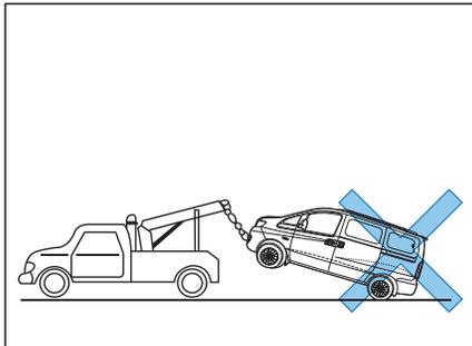
Evite rebocar um veículo elétrico com o eixo de tração tocando o solo. Isso pode danificar gravemente o motor elétrico e o sistema de transmissão porque: O motor elétrico continua girando enquanto as rodas motrizes estão no chão, podendo gerar eletricidade sem controle. Sem refrigeração ativa, o sistema pode superaquecer e queimar componentes internos. A regeneração de energia descontrolada pode danificar inversores e módulos eletrônicos.
