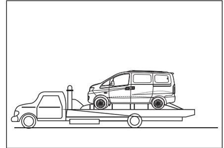
A melhor forma de transportar o seu veículo é sob uma plataforma plana basculante, como mostrado na figura.
