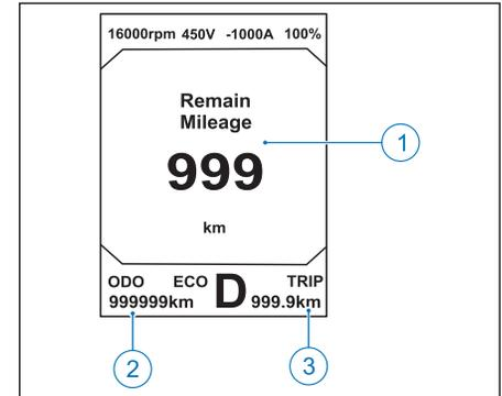
Quando a chave de partida do veículo está na posição ON, o display LCD exibirá as informações de marcha, tensão, corrente, carga da bateria, consumo médio em kW/100km, hodômetro parcial e hodômetro total.
