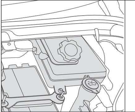
Abra o capô e verifique o fluido de freio no reservatório regularmente. O reservatório está localizado ao lado esquerdo do motor. O nível de líquido deve estar entre as marcas de “MIN” (mínimo) e “MAX” (máximo) na lateral do reservatório. Durante a condução, devido ao desgaste e ao ajuste automático das pastilhas de freio, o nível do líquido cairá ligeiramente, o que é normal.
