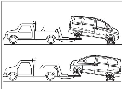
O caminhão de reboque é conectado na parte inferior do pneu do veículo (roda dianteira ou traseira) com dois braços, e as rodas ficam fora do solo. As outras duas rodas estão no chão. Este é um método viável para rebocar seu veículo.
