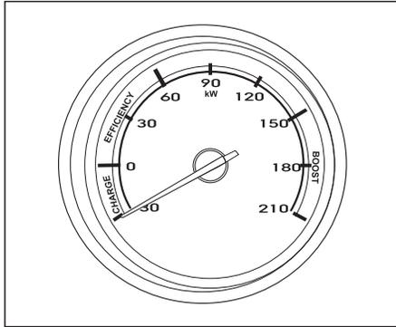
Indica o fluxo de energia atual, Na área em vermelho indica consumo (POWER) e na área verde recarga (CHARGE). Pode ser utilizado como referência para obter uma condução mais econômica. A área vermelha é uma descarga de alta potência, que pertence ao aviso de alarme.
