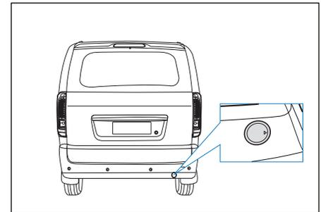
1. Remova o gancho de reboque no kit de ferramentas do veículo. Pressione a tampa do furo no para-choque traseiro.
