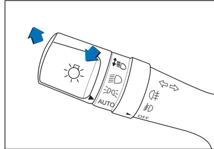
Gire o interruptor na extremidade da alavanca para a posição de farol baixo e empurre a alavanca para frente (direção do painel) até ouvir um clique para ligar o farol alto. Enquanto o farol alto estiver acesso o indicador no painel de instrumentos permanecerá acesso. Puxe a alavanca para trás para voltar para o farol baixo.
