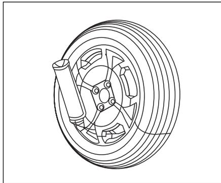
1. Agite o líquido selante de pneu bem antes do uso, e remova a capa protetora conectada a válvula.
