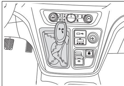
O seletor de marcha é um sistema eletrônico de mudança de marcha com 3 posições: “D” (conduzir), “R” (marcha à ré) e “N” (neutro) e a posição atual do seletor é exibida no painel;
