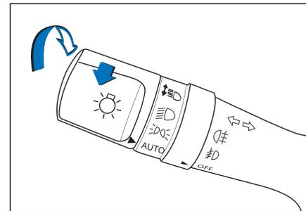
Você pode controlar as luzes girando a extremidade da alavanca. Quando é girado para a posição , a luz de posição, a luz da placa, o painel de instrumento e a luz de fundo dos botões serão acesos.
