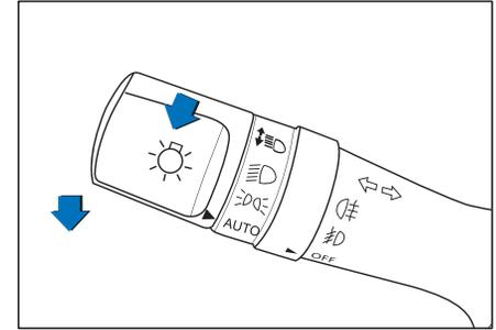
Para lampear o farol alto, puxe a alavanca levemente para trás e solte-a. Neste momento, a luz do farol alto irá acender e logo apagar. Mesmo se a alavanca estiver na posição “OFF”, o farol irá piscar. Se a alavanca for puxada e não for liberada rapidamente, a luz do farol alto permanecerá acesa enquanto a alavanca permanecer puxada.
