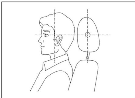
O apoio de cabeça oferece proteção máxima quando o centro do apoio de cabeça está nivelado com a parte superior das orelhas do condutor.
