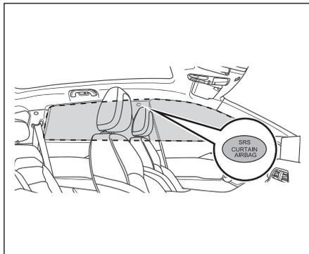
O Airbag de cortina está localizado na borda inferior do teto; Você pode encontrar marcas de Airbag no pilar. O Airbag de cortina é um complemento ao cinto de segurança. Em caso de colisão lateral, o Airbag de cortina reduzirá o ferimento na cabeça dos passageiros dentro do veículo, além de prevenir outras colisões.
