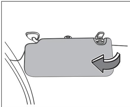
O veículo está equipado com um para-sol que deve ser puxado para baixo para proteger o condutor e o passageiro da luz solar dianteira.
