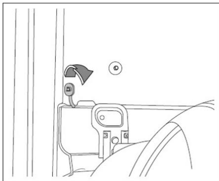
2. Desparafuse a tampa do tanque de combustível no sentido anti-horário e coloque-a no suporte dentro da tampa de enchimento.
