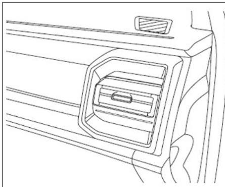
Na saída de ar ao lado do passageiro, vire a pá para cima e para baixo, para a esquerda e para a direita, respectivamente, para regular a direção do fluxo de ar.
