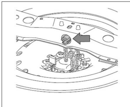
3. Gire a chave da porca da roda ⑤ no sentido anti-horário na outra extremidade da manivela combinada, e o pneu sobressalente cairá lentamente do chassi do veículo para o chão. Retire o pneu sobressalente.
