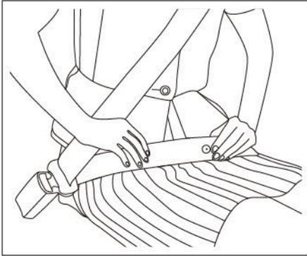
Você deve abaixar o cinto de segurança para seu quadril, não sua cintura. Se o cinto de segurança for colocado muito alto e ocorrer um acidente ou frenagem de emergência, o corpo poderá escorregar para fora da parte inferior e causar ferimentos.
