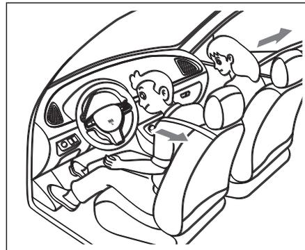
Se o seu veículo estiver equipado com um dispositivo de pré-tensionamento dos cintos de segurança. Em certos tipos de colisões, o sistema de pré-tensionamento do cinto pode ser ativado junto com o sistema de Airbag. O sistema de pré-tensionamento do cinto de segurança funciona com um retrator do cinto de segurança para ajudar você e os demais passageiros a prender o cinto de segurança imediatamente em alguns casos de colisão.
