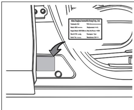
Conforme mostrado na figura acima, a placa de identificação do veículo está localizada sob a coluna B.
