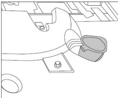
Verifique frequentemente o nível de fluido do lavador de para-brisa. Se estiver insuficiente, por favor, reabasteça-o em tempo hábil. Sob condições de clima frio, o fluido do lavador pode congelar e se expandir. É proibido encher o nível de fluido superior a três quartos do reservatório de fluido, caso contrário o reservatório de fluido do lavador de para-brisa pode ser danificado.
