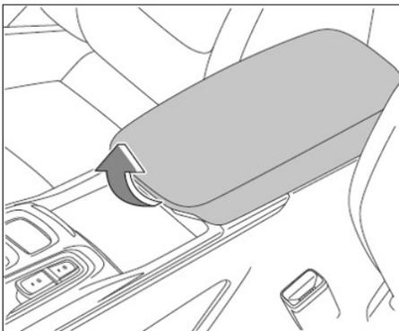
Puxe tampa superior para abrir a caixa do apoio de braço, empurre o apoio de braço para fechá-lo.
