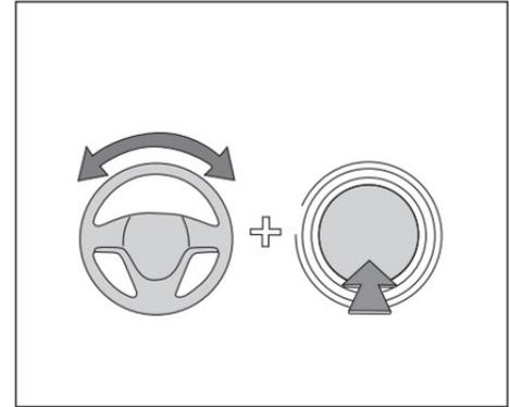
Quando o motor é ligado, se o indicador no interruptor de ignição piscar em verde, ele indica que o ESCL (Electronic Steering Column Lock - Trava eletrônica da coluna de direção) não foi desbloqueado. Neste momento, vire suavemente o volante para a esquerda e para a direita enquanto pressiona o interruptor de ignição para desbloquear o ESCL.
