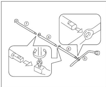
2. Insira a barra de manivela ⑦ da manivela combinada na abertura oval central abaixo do painel da porta traseira e acople-a com a ranhura de abertura do elevador de pneus sobressalente na parte inferior do veículo.
