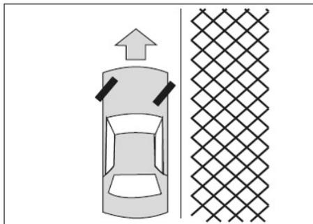
(2) Quando estacionar o veículo em uma subida e houver pedras de meio-fio, vire as rodas para longe das pedras do meio-fio, mova lentamente o veículo para trás até que as rodas do lado das pedras toquem levemente as pedras do meio-fio e aplique o freio de estacionamento.
