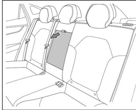
Para virar o apoio de braço, puxe o laço de tecido no assento do meio. Para virar o apoio de braço para trás, vire o apoio de braço do meio e pressione-o no encosto do banco traseiro.
