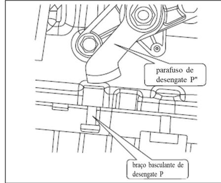
4. Em seguida, use uma chave Allen de 6 mm para girar o "parafuso de desengate P" no sentido anti-horário até que o parafuso seja apenas separado do "braço basculante de desengate P", e então a engrenagem P pode ser restaurada.
