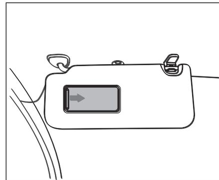
Um espelho está posicionado no para-sol do lado do passageiro. Para utilizar puxe para baixo o para-sol e deslize a tampa protetora do espelho para o lado
