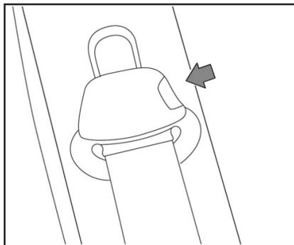
Pressione o botão de liberação e ajuste a altura do cinto diagonal para a posição mais adequada. Solte o botão de ajuste para travar o dispositivo do cinto diagonal na posição.
