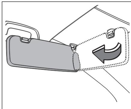
Quando houver necessidade de utilizar proteção contra o sol lateral, pode-se desencaixar o para-sol do suporte e girar ele em direção à porta.
