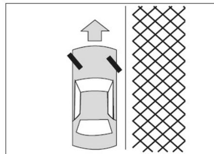
(3) Quando você subir ou descer para estacionar o veículo e não houver pedras de meio-fio, coloque pedras ou blocos na como calços nas rodas para evitar o movimento acidental do veículo.
