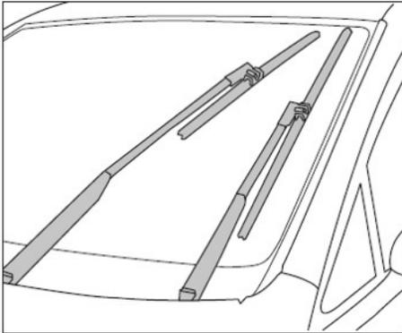
O limpador dianteiro só pode ser totalmente levantado na posição de manutenção. Mova o limpador para a posição de manutenção da seguinte maneira:
