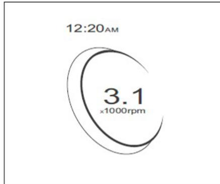
O conta-giros do motor mostra a rotação do motor por minuto, em 1000 rpm.
