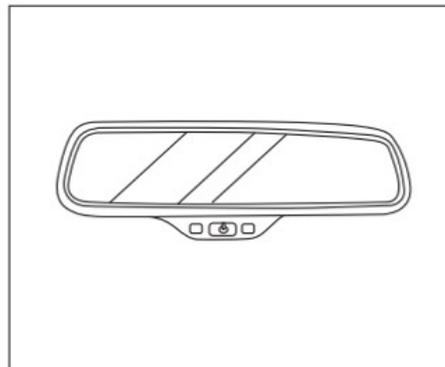
Quando o interruptor de ignição é ajustado para a posição "ON", a função antirreflexo automática é ativada por padrão. O espelho retrovisor interno reduzirá automaticamente o reflexo de acordo com a intensidade luminosa do farol do veículo atrás. Pressione este interruptor novamente para desativar a função antirreflexo automática.
