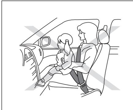
Selecione um sistema de retenção infantil adequado e certifique-se de instalar e usar o sistema em estrita conformidade com as instruções do fabricante.
