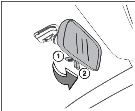
**Posição diurna normal:** ajuste a alavanca de operação antirreflexo sob o espelho retrovisor para a posição mostrada na figura ① .
