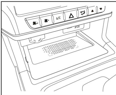
Quando o veículo e o dispositivo móvel tiverem a função de carregamento sem fios, ligue a alimentação do veículo para carregar o dispositivo móvel colocado na área de carregamento.
