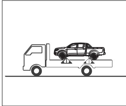
A melhor forma de transportar o seu veículo é em plataforma plana basculante, como mostra na figura.
