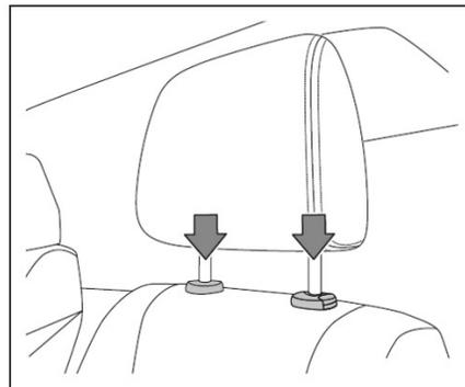
1. Alinhe as hastas do encosto de cabeça com o orifício nos encostos do banco. Certifique-se de que o encosto de cabeça está voltado para a direção correta. A haste do encosto de cabeça com uma ranhura deve ser instalada no orifício com um botão de bloqueio.
