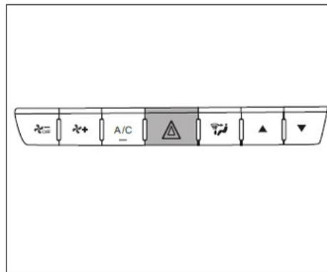
Se não for possível mover o veículo para uma área segura no caso de um mal funcionamento ou acidente de trânsito durante a condução, a luz de pisca-alerta deve ser ligada imediatamente para alertar os veículos e pedestres para prestar atenção.
