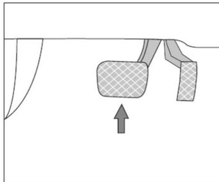
O sistema de freios atua no pedal de freio. A principal função do sistema de freios é reduzir a velocidade ou até mesmo parar o veículo em movimento, atuando no pedal do freio, de modo a manter estável o decréscimo de velocidade do veículo e manter o veículo parado. Se você precisar parar por um longo período, recomenda-se usar freio de estacionamento.
