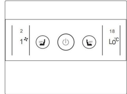
Se seu veículo estiver equipado com a função de aquecimento do banco e o interruptor de ignição estiver no modo "ON", clique no botão de aquecimento do banco ou no multimídia para ativar a função de aquecimento dos bancos. Clique novamente para selecionar a intensidade de aquecimento e clique em "OFF" para desativar a função de aquecimento do banco.
