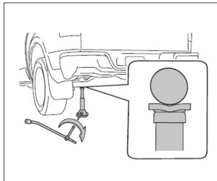
5. A barra de manivela ⑦ da manivela combinada usada para a remoção do pneu sobressalente é causada para prender a alça do macaco.
