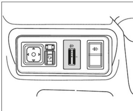
Quando o interruptor de ignição está na posição "ON" (ligado) e os faróis estão ligados, o motorista pode ajustar o ângulo do feixe do farol através do botão de ajuste de altura do farol.
