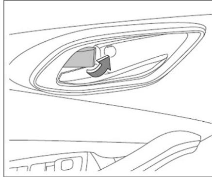
Nas quatro portas, use a maçaneta interna para destravá-las ou trancá-las, independentemente do estado do veículo.
