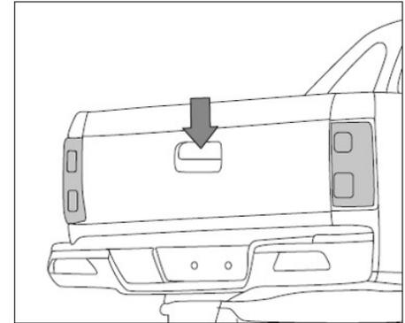
Para abrir a tampa traseira, puxe a maçaneta de abertura da porta traseira para destravar a trava da tampa traseira. Puxe a porta tampa para trás e baixe-a lentamente para uma posição horizontal com as duas mãos.
