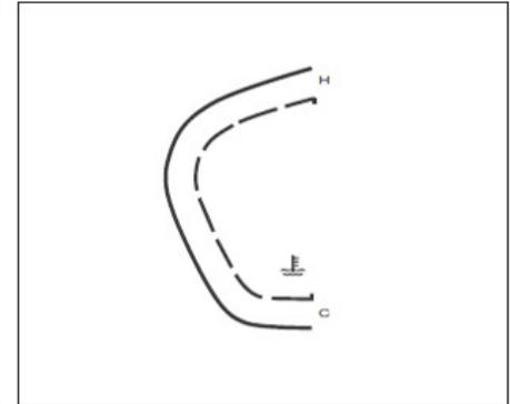
Quando o interruptor de ignição está na posição "ON" (ligado), o termômetro de água do motor exibe a temperatura atual do líquido de arrefecimento do motor, sendo o limite superior marcado como "H" (HIGH - alto) e o limite inferior marcado como "C" (COOL - frio).
