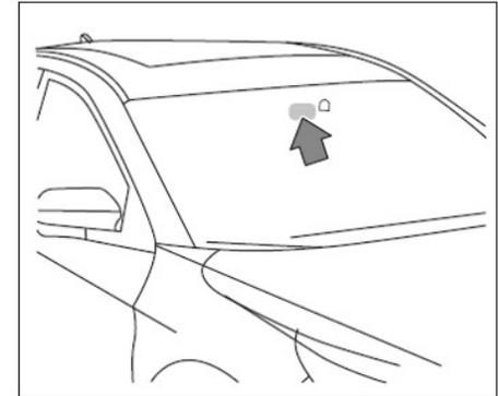
Local dedicado para instalação de dispositivos de identificação eletrônica do veículo, tags de pedágio e etiquetas transmissoras de informações.
