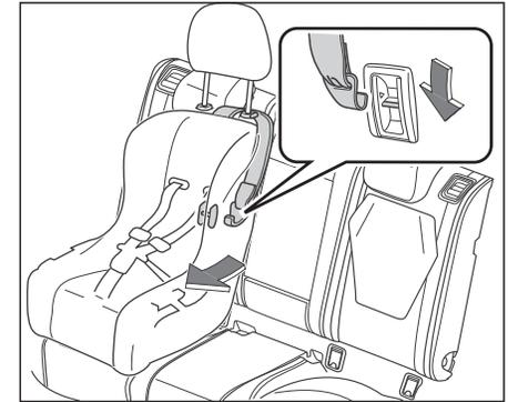
4. Trave o encosto do banco traseiro e deslize o mecanismo de travamento do assento infantil na ancoragem inferior para garantir que os dois mecanismos de travamento ISOFIX estejam devidamente fixados.
