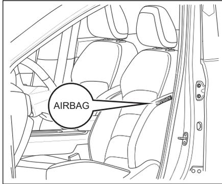
O Airbag lateral está localizado dentro do encosto do banco, fora do forro, e o sinal do Airbag está no encosto. O Airbag lateral é o complemento do cinto de segurança. Em caso de colisão lateral, o Airbag lateral reduzirá os danos aos ocupantes e evitará colisões subsequentes.
