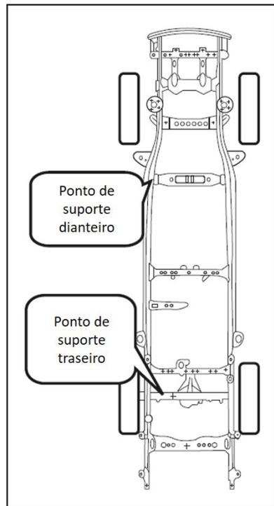
4. Coloque o macaco em um terreno plano e duro e ajuste a posição do macaco para que ele fique alinhado diretamente abaixo do ponto de elevação do veículo, enquanto a parte superior do macaco entra em contato com o ponto de macaco.
