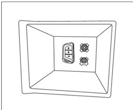
A antena sobressalente está disposta na parte inferior da caixa de apoio de braço (com um padrão de chave). Por favor, coloque a chave nesta posição quando a bateria estiver fraca. A antena irá detectar e identificar a chave a curta distância.
