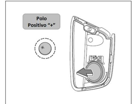
5. Instale a bateria nova na ordem reversa à desinstalação.
