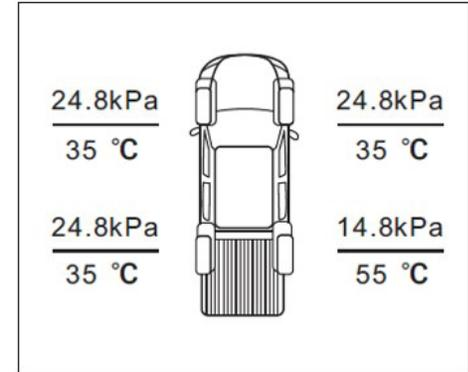
O estado atual do pneu pode ser exibido na tela de info entretenimento. Clique no ícone de monitoramento da pressão dos pneus na tela de info entretenimento para entrar na interface de exibição de pressão e temperatura dos pneus. A pressão atual dos pneus do veículo também pode ser exibida no painel de instrumentos.
