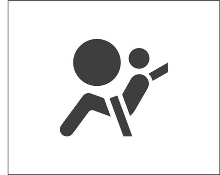
A luz de advertência do Airbag monitora o estado do sistema de Airbag, o circuito do sistema de pré tencionamento do cinto de segurança e todos os circuitos relacionados. Quando a chave de partida é colocada na posição “ON”, o sistema realizará primeiro uma autoverificação e a luz de advertência do Airbag ficará acesa por alguns segundos e depois apagará, indicando que o sistema está funcionando normalmente.
