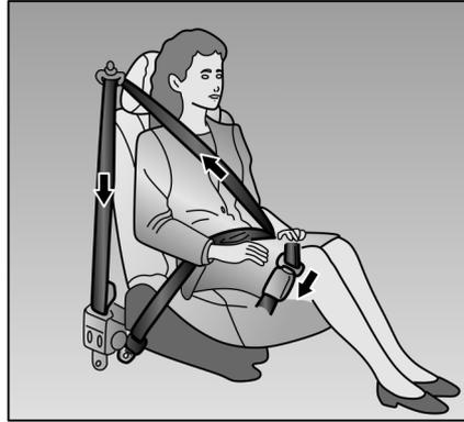
O veículo está equipado com pré-tensionadores nos cintos de segurança para o motorista e o passageiro do banco dianteiro. O dispositivo está instalado para proporcionar segurança ao motorista e ao ocupante do banco dianteiro em caso de colisão frontal. Em colisões sérias, o cinto de segurança e airbag irão funcionar simultaneamente. Os pré-tensionadores do cinto de segurança parte do mesmo princípio do travamento retrátil.
