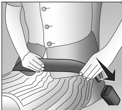
Para utilizar o cinto de segurança de dois pontos fixos, insira a lingueta de trava na fivela. Pressione a lingueta de trava na fivela até ouvir o som de travamento. Verifique se o cinto de segurança está travado corretamente, não está dobrado ou torcido.
