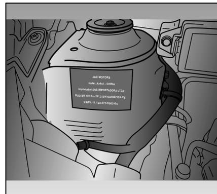
Este VIN está localizado na coluna da suspensão, no interior do compartimento do motor.
