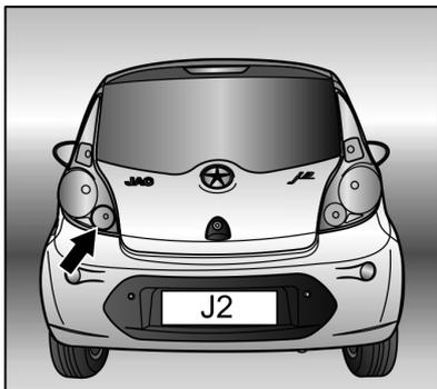
A luz de neblina traseira é usada para alertar motoristas e pedestres sobre a posição de seu veículo em condições de pouca visibilidade, tais como neblina e chuva intensa, para evitar acidentes.
