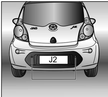
Se o sistema sensor de ré detectar a presença de um objeto a até 120 cm atrás do veículo durante uma manobra de ré, é emitido um aviso sonoro para alertar o motorista. Este é um sistema meramente auxiliar.
