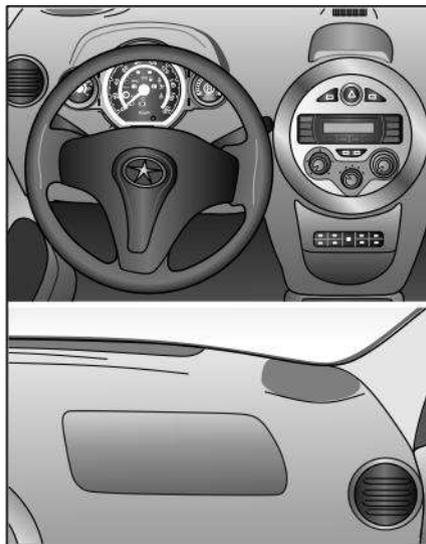
O veículo está equipado com sistema de proteção auxiliar (airbag). O nome completo desse sistema "SRS AIRBAG" está no volante, no painel e na tampa do painel acima do porta-luvas.
