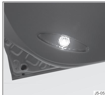
A luz de cortesia da porta acenderá ao abrir as portas dianteiras. A luz de cortesia da porta fica localizada na parte interna das portas. Ao fechar qualquer uma das portas, a luz de cortesia correspondente se apagará.
