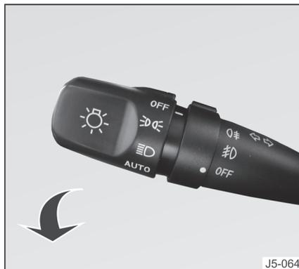
A luz alta acenderá ao girar o interruptor no formato de cúpula na extremidade do interruptor combinado para a posição do símbolo de luz alta, empurrando ao mesmo tempo a alavanca de controle afastando-a do seu corpo. Nesse caso, a luz alta e a luz indicadora correspondente acenderão simultaneamente. Para mudar para luz baixa, puxe a alavanca de controle em direção ao seu corpo.
