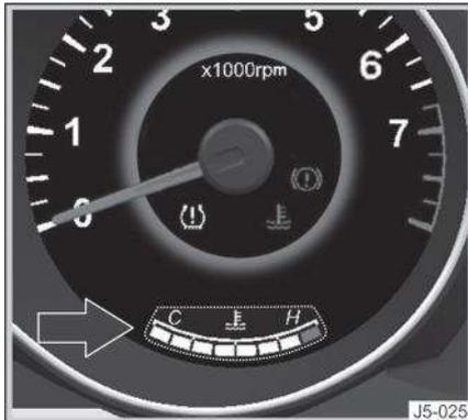
Indica a temperatura do líquido de arrefecimento. As luzes do indicador de nível de temperatura da água devem estar acesas dentro da faixa normal. Se as luzes atingirem a faixa vermelha pare imediatamente o veículo, desligue o motor e abra o capô para verificar o nível do líquido de arrefecimento e a correia de acionamento da bomba de água.
