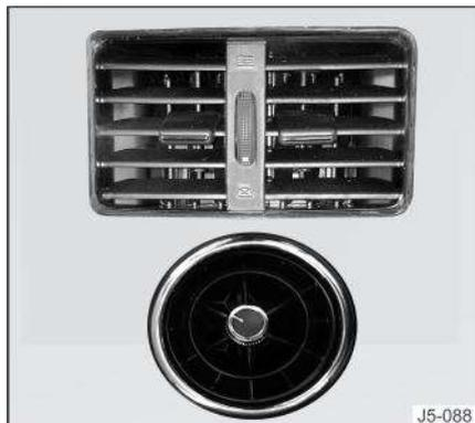
Para mudar a direção do fluxo de ar nos difusores de saída de ar central ou traseiros, mova o regulador das pás verticalmente ou horizontalmente até que a direção desejada seja atingida. Gire o botão vertical para cima ou para baixo para abrir ou fechar as saídas de ar.
