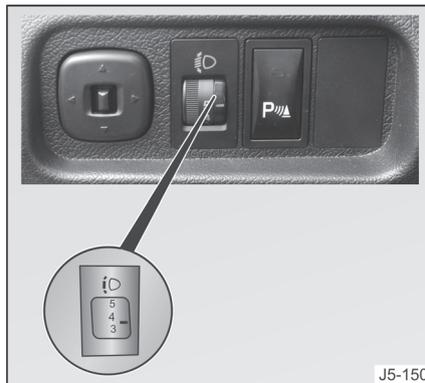
O ajuste elétrico dos faróis permite ajustar a altura do foco de luz dos faróis dianteiros.
