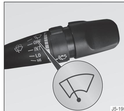
Para usar o lavador do para-brisa, puxe a alavanca de controle do limpador/lavador em sua direção. Quando o lavador estiver ativado, o pulverizador de água esguichará o fluido de limpeza pelo bico do esguicho do para-brisa. Ao mesmo tempo, o limpador funcionará sem interrupção até que a alavanca de controle seja liberada.
