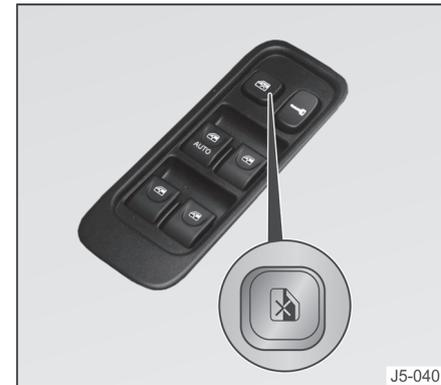
Controle de travamento dos vidros situado no painel de controle principal bloqueia o acionamento livre do vidro da porta dianteira do passageiro e dos vidros das portas traseiras. Pressione o botão de controle de travamento dos vidros para que os controles do vidro da porta dianteira do passageiro e dos vidros traseiros não funcione. O motorista pode controlar todos os vidros travados.
