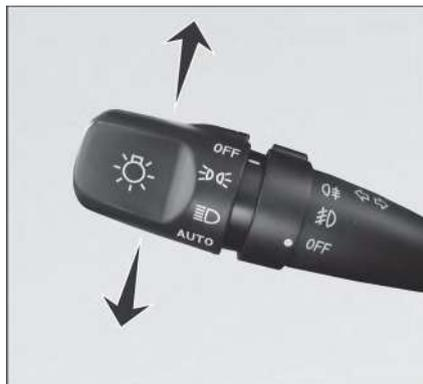
Você pode sinalizar sua intenção de mudar de direção ou de pista a outros veículos ou pedestres por meio do interruptor das luzes indicadoras de direção. A luz indicadora de direção acenderá somente se o interruptor de ignição estiver ligado.
