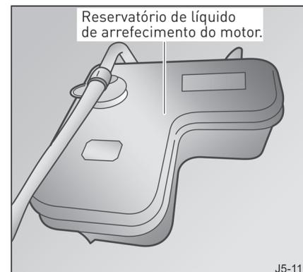
Ao medir o nível do líquido de arrefecimento, certifique-se de que a temperatura do motor seja igual à temperatura ambiente. Se o nível de líquido de arrefecimento reduzir até ou abaixo da marca **L**, será necessário adicionar a quantidade adequada de líquido de arrefecimento até que o nível atinja sua posição normal.
