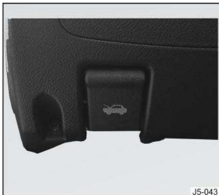
O interruptor de liberação do capô fica localizado na parte inferior do lado esquerdo do console da cabine do motorista. O procedimento de abertura/fechamento é como a seguir:
