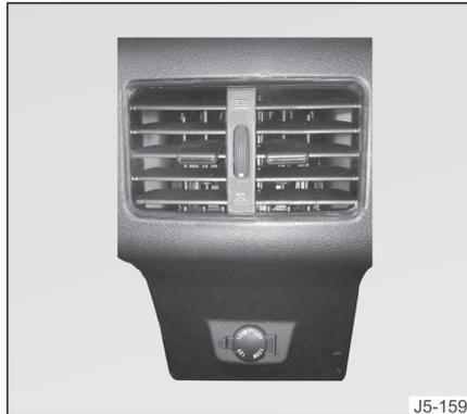
O seu veículo está equipado com uma tomada elétrica de 12 V para que você possa usar vários produtos eletrônicos ou carregá-los facilmente a bordo.
