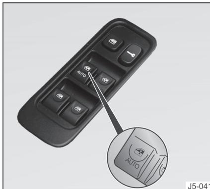
O interruptor do vidro do motorista possui 2 estágios para abertura. No primeiro estágio, o controle é manual. Basta pressionar o interruptor levemente e soltá-lo assim que o vidro atingir a posição desejada. No segundo estágio, ao pressionar o botão mais profundamente se abre completamente. No entanto, é possível interromper a descida ao puxar o botão para cima.
