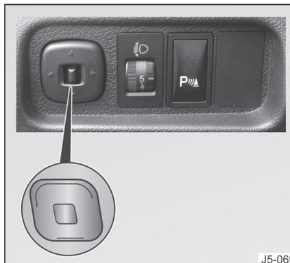
Antes de conduzir o veículo, ajuste os espelhos retrovisores externos na posição adequada para garantir ampla visão posterior.
