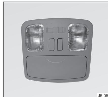
Com o interruptor na posição central, as luzes se acendem ao desativar o alarme ou ao abrir alguma porta. Ao fechar as portas, as luzes se apagam gradualmente após 30 segundos ou imediatamente após inserir a chave de ignição no contato e move-la para a posição ACC.
