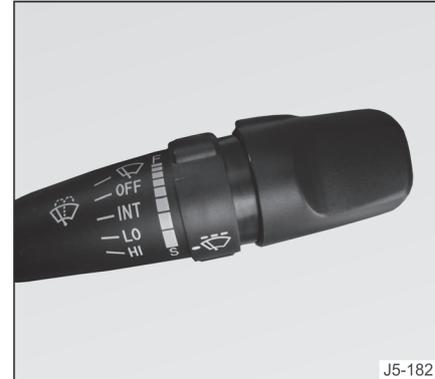
Ao girar o interruptor de ignição para a posição **ON**, os interruptores do limpador ou lavador do para-brisa funcionarão. As posições do interruptor são as seguintes:
