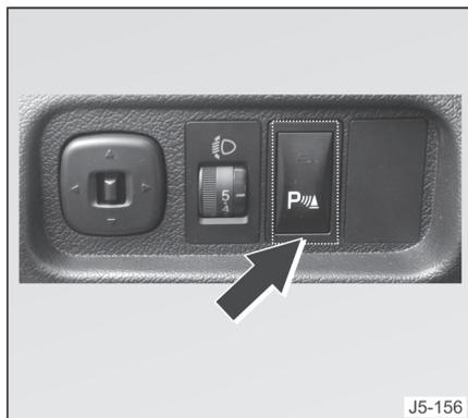
O sensor de estacionamento proporciona ao condutor uma ajuda auxiliar para detectar obstáculos ao estacionar ou manobrar o veículo em baixa velocidade. O sensor irá alertar com um alarme sonoro se detectar um objeto a cerca de 100 cm em relação a frente do veículo e a cerca de 150 cm em relação a traseira do veículo.
