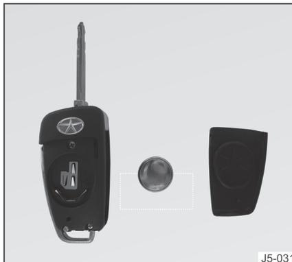
Quando a bateria do controle remoto estiver fraca, poderá ser necessário pressionar várias vezes o botão para travar ou destravar o veículo. Nesse caso, a luz indicadora permanecerá apagada. Substitua a bateria o quanto antes.
