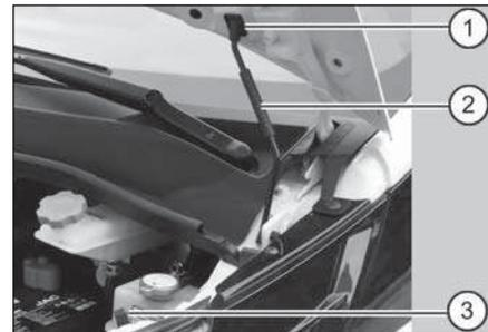
3. Desloque a barra de sustentação (2) de sua garra de descanso (3) e encaixe a mesma no orifício de apoio (1), mantendo assim o capô suspenso.
