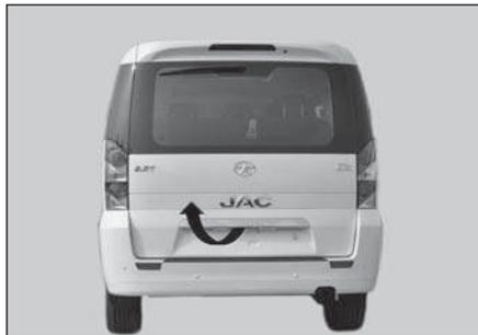
Para abrir a porta do compartimento de bagagem, puxe a maçaneta externa para fora com a tecla da central de travamento na posição de “destravamento” e levante a porta. Para fechar, abaixe a porta e feche com cuidado.
