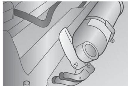
Utilização do extintor de incêndio: pare o veículo e desligue o motor imediatamente; O extintor se encontra na parte inferior/frontal entre os bancos dianteiros, solte a presilha e remova-o; acione o extintor conforme instruções do fabricante impressas no próprio extintor.
