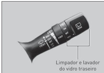
Acione o limpador e lavador do vidro traseiro usando a alavanca de operação no lado direito da coluna direção. Esta função só pode ser operada quando a chave de ignição está ligada (posição ON).
