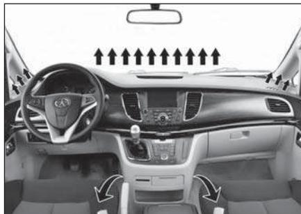
A maior parte do fluxo de ar é direcionada para o assoalho. Um pequeno volume de ar é soprado para o desembaçador (descongelamento), para os difusores laterais do painel de instrumentos e para o para-brisa.
