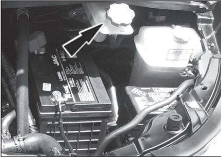
Quando for necessário adicionar fluido de freio, use fluido DOT 4 novo. Consulte Especificações de fluidos no capítulo VII. Antes de abrir a tampa do reservatório do fluido de freio, limpe a tampa e a superfície ao redor da mesma. Assim você estará impedindo a entrada de sujeira no reservatório.
