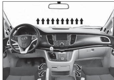
O fluxo de ar se divide em duas partes e sopra para a ventilação, para o assoalho, para o desembaçador do para-brisa e desembaçadores laterais.
