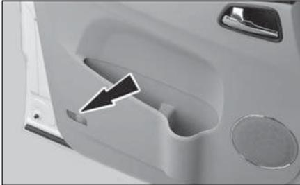
Quando a porta dianteira direita ou esquerda é aberta, o interruptor é acionado e a luz de cortesia da porta correspondente é acesa. A luz de cortesia é inserida no interior da porta. Ao ser fechada, a luz de cortesia da porta correspondente é desligada.
