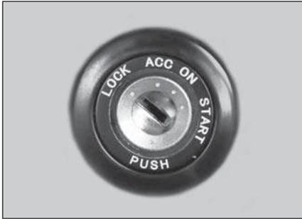
Depois de inserida no interruptor de ignição, a chave de ignição pode ser colocada em quatro posições diferentes:
