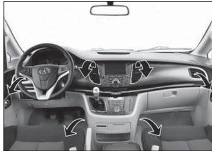
O fluxo de ar é dividido em duas partes e então sopra pela ventilação central, ventilação lateral e ventilação para o assoalho.
