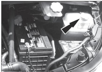
O reservatório de expansão do líquido de arrefecimento está localizado no lado esquerdo do compartimento do motor. Para obter a localização exata, consulte Compartimento do motor.
