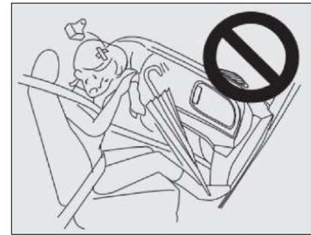
Não coloque caixas, guarda-chuva e objetos diversos no painel. Isto influenciará no funcionamento do airbag, e o risco destes objetos voarem quando o airbag for detonado.
