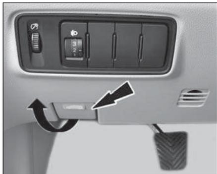
A alavanca de liberação do capô do motor está localizada na parte inferior esquerda do painel de instrumentos. A operação de abertura e fechamento do capô é a seguinte:
