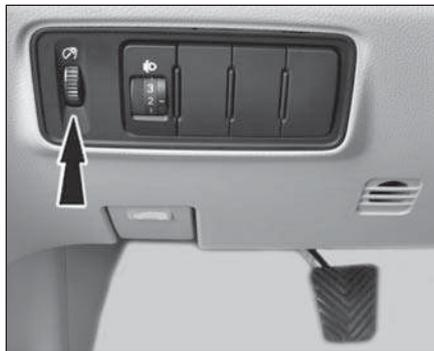
Permite regular a iluminação de fundo do painel de instrumentos.
