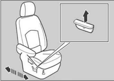
Puxe a alavanca de ajuste para cima ou para baixo, desloque o banco para a posição desejada e solte a alavanca. Assegure-se de que o banco está travado na posição tentando mover o banco para frente e para trás.
