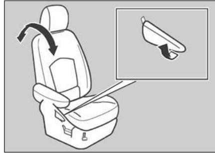
Para ajustar a inclinação do encosto, levante a alavanca localizada na lateral inferior do assento e mova o encosto para a posição desejada. Finalmente, solte a alavanca travando o encosto.
