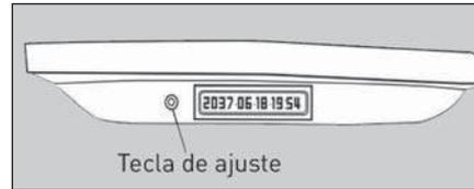
O relógio digital fica localizado na parte superior central do painel de instrumentos, a tecla de ajuste está do lado esquerdo do painel do relógio.
