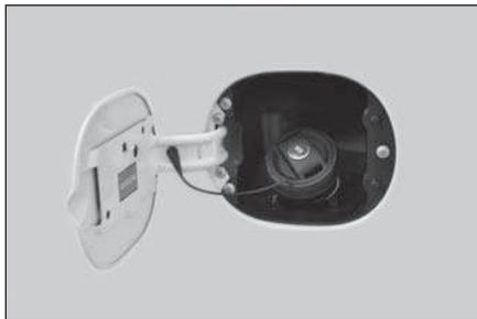
O bocal de abastecimento de combustível está localizado na lateral traseira esquerda do veículo.
