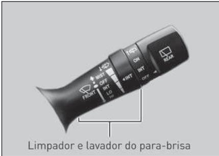
Acione o limpador e lavador do para-brisa usando a alavanca de operação no lado direito da coluna direção. Esta função só pode ser operada quando a chave de ignição está ligada (posição ON).
