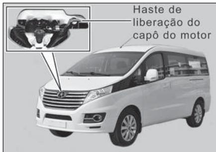
2. Coloque sua mão no lado interno da borda dianteira do capô para alcançar e liberar a haste e levante o capô do motor.
