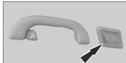
Existem duas luminárias em ambos os lados do teto traseiro. O interruptor das luminárias traseiras tem duas posições, respectivamente "DESLIGADA" e "LIGADA".
