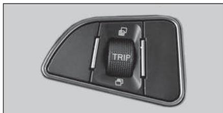
Todas as informações do computador de bordo podem ser selecionadas e reiniciadas por meio do acionamento do botão TRIP localizado a esquerda do volante de direção.
