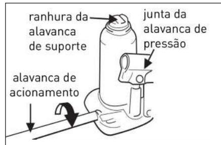
Gire no sentido anti-horário a alavanca do macaco para fechar a válvula de alívio de pressão. Coloque a alavanca no soquete e a seguir alinhe a ranhura da chave na ranhura do macaco com o ressalto no soquete. Eleve o veículo na altura correta, e instale a roda sobressalente.
