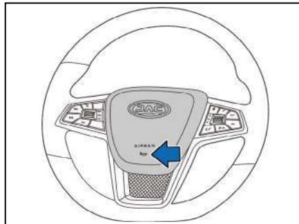
Pressione a marca da buzina no volante para acionar a buzina. Verifique a situação da buzina regularmente e confirme se a buzina pode funcionar normalmente.
